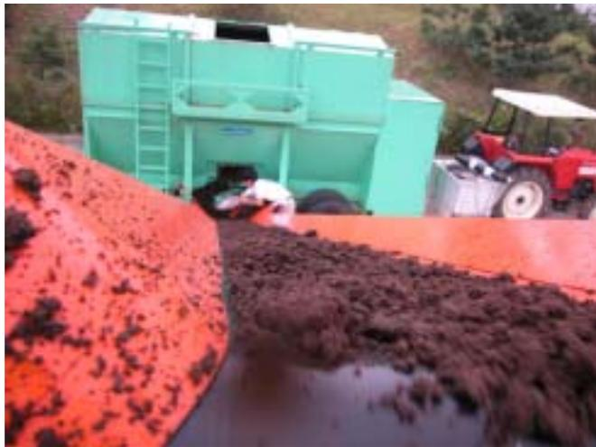
그림 3-12. 버섯배지의 배출량 시험
