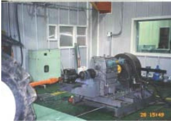
그림 2-23. 다이내모메터를 이용한 토오크메터의 검정
