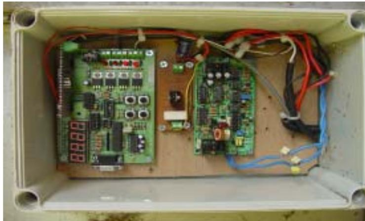
그림 3.1.26. 자동 급이기에 설치된 개체인식장치
