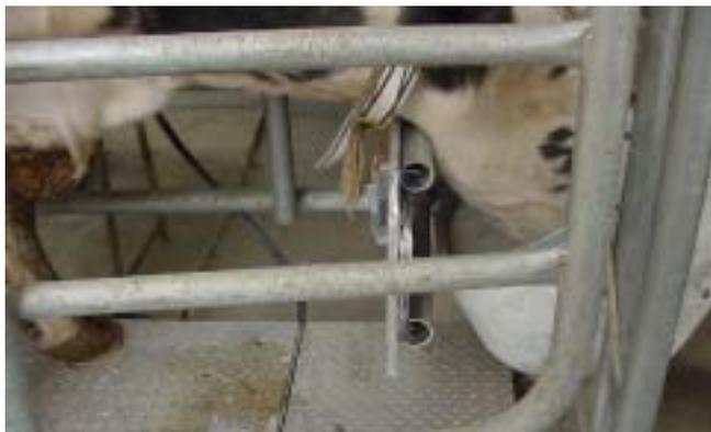
그림 3.1.29. 착유실에 설치된 1차 코일과 고유코드발생기의 접촉면 관계
