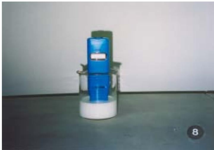
그림 3.3.22. 상유를 이용한 유즙전도도 측정
