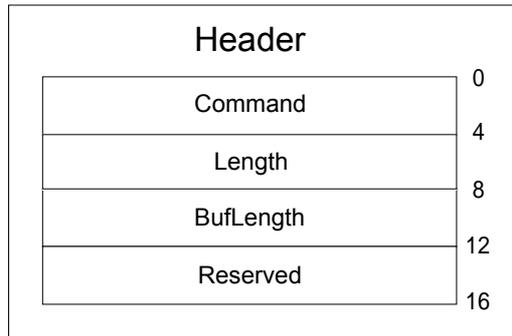
그림 3.5.13. Header packet
