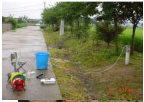
그림 25. 단공 주입-양수 시험 (증평 문화마을)부지
