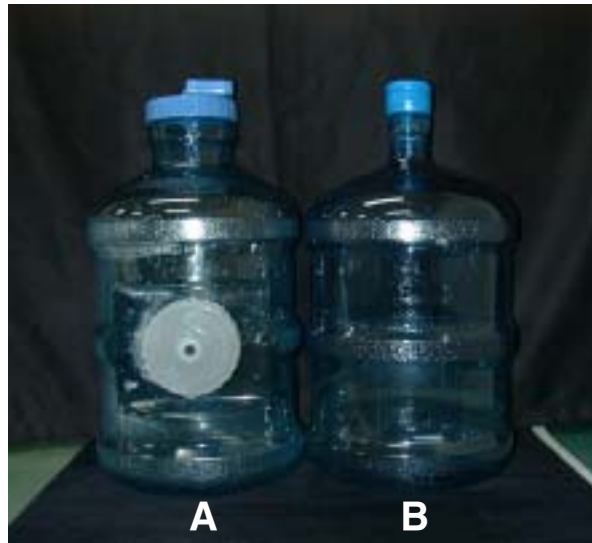
그림 9. 쪽파의 대량배양에 활용될 생수물통의 모습. A; 입구가 넓어 쪽파의 배양에 활용이 가능한 배양기. B; 현재 사용되고 있는 생수통.
