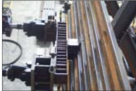
그림 2.3.13 가력부 체결 모습
