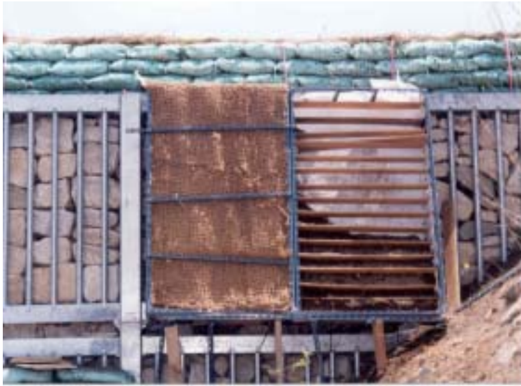
그림 3.2.11 그린톱 댐체사면녹화시험 녹화상 틀
