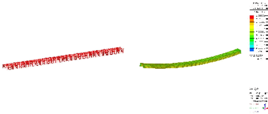
그림 2.2.11 브레이싱재 모델링과 응력검토
