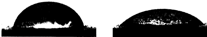
그림 1. 무처리목재에 떨어진 물방울의 영상(왼쪽 : 0초경과 오른쪽 : 30초경과)
