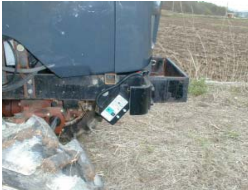
그림 36. 프론트 액슬브라켓에 장착된 속도 센서 모습
