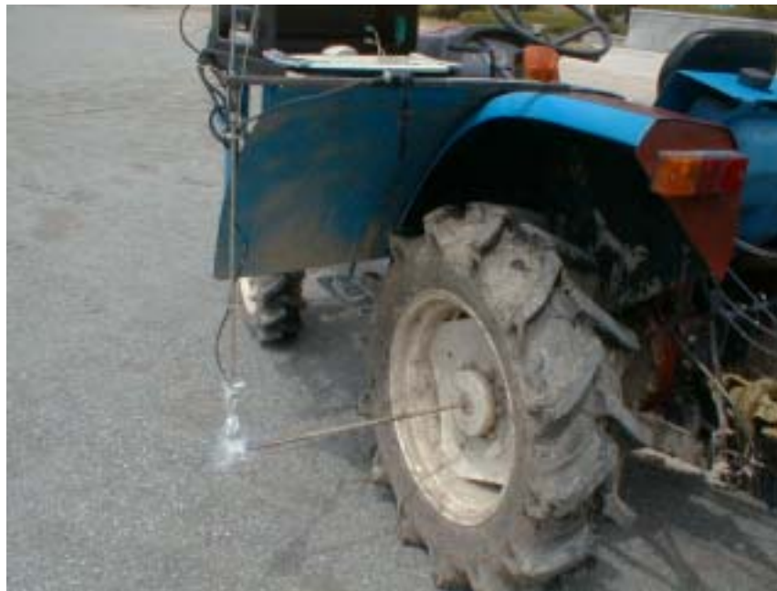
그림 37. 좌측 뒷차축에 설치된 로터리 엔코더 모습
