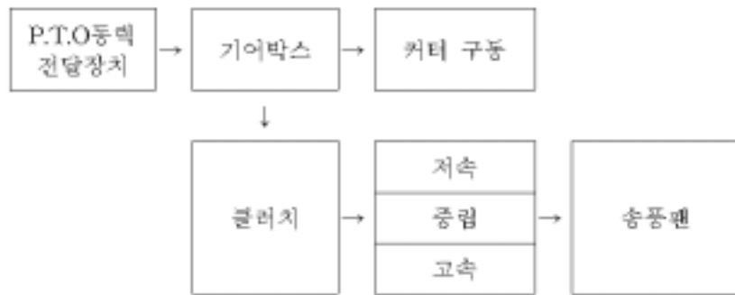
그림 34 트랙터 P.T.O 동력에 의한 동력전달장치
