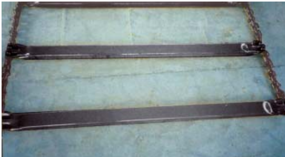
그림 26 베일이송장치(체인 및 이송판)
