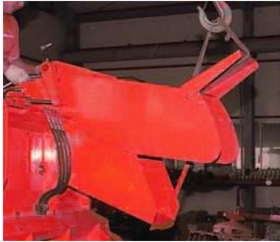
그림 24 배출방향 조절장치 조립 장면
