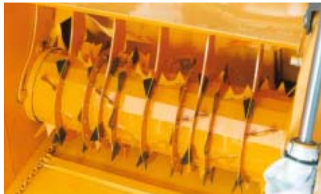
그림 11 샘플기대의 칼날축부 상세 사진
