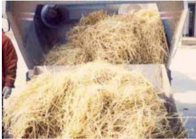
그림 66 TMR 배합성능시험을 위한 볏짚 투입 모습
