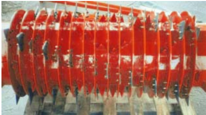
그림 16 제작완료된 회전날 프레임
