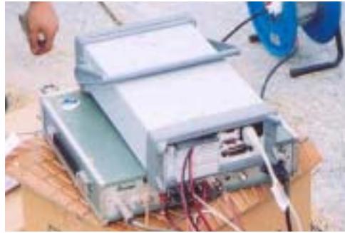
그림 72 토크미터 및 데이터수집 기의 설치모습
