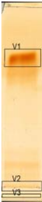
Fig.1. TLC plate에 sample을 spotting후 hexane/diethylether(7 : 3,v/v) 으로 포화되어 있는 TLC tank에 넣고 전개 시킨 TLC plate.
