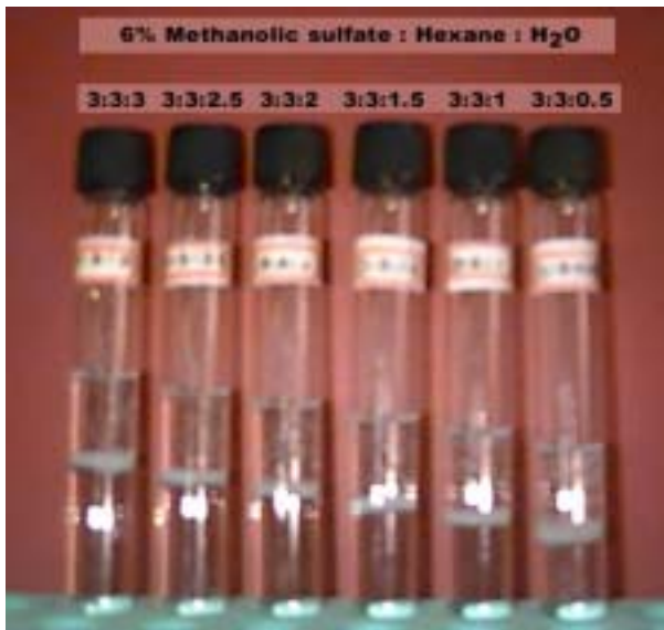
Fig.2. 6% Methanolic sulfate로 70℃에서 24hr 동안 Methylation 시킨후 hexane 3ml씩을 넣고 vortex한 후 H 2 O를 0.5, 1, 1.5, 2, 2.5, 3ml 넣은 후 나타난 phase 형성결과.
