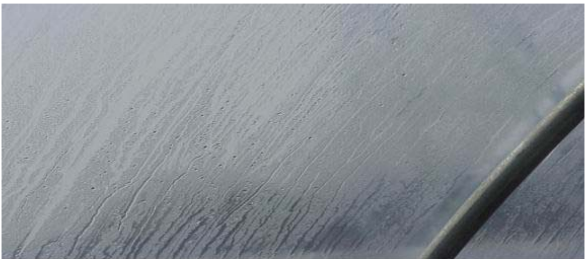
현장사진 6 : 14번 하우스 => 필름 코팅불량으로 인한 유적불량
