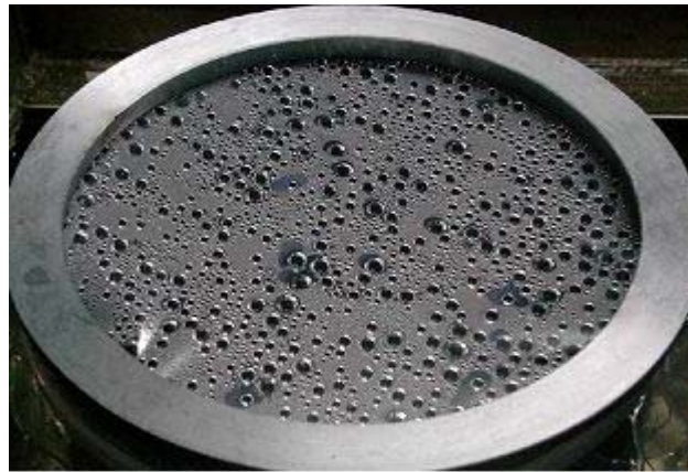
<그림 19> 무적 미처리 필름의 무적성 육안관찰 결과
