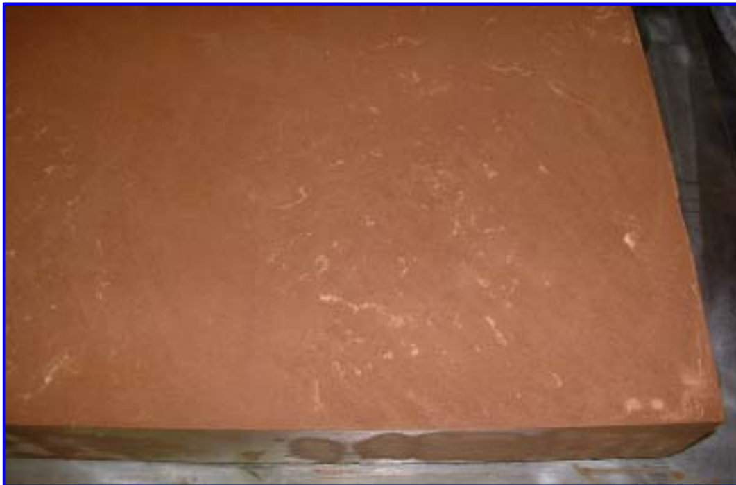
사진 10. 750×500×80mm 황토발포 PLATE 시험체 가공후 표면형상
