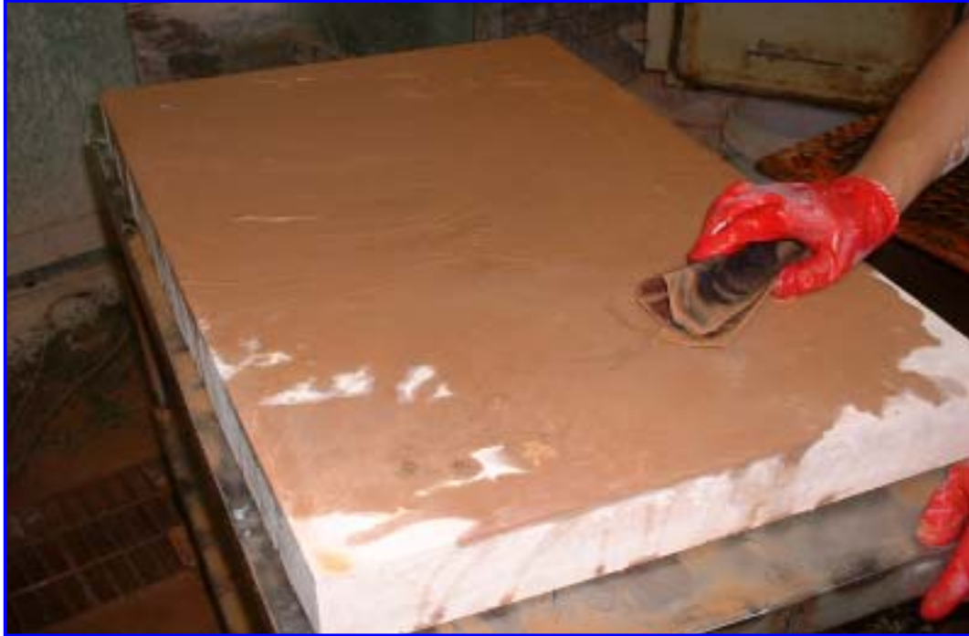
사진 9. 750×500×80mm 황토발포 PLATE 시험체 표면가공
