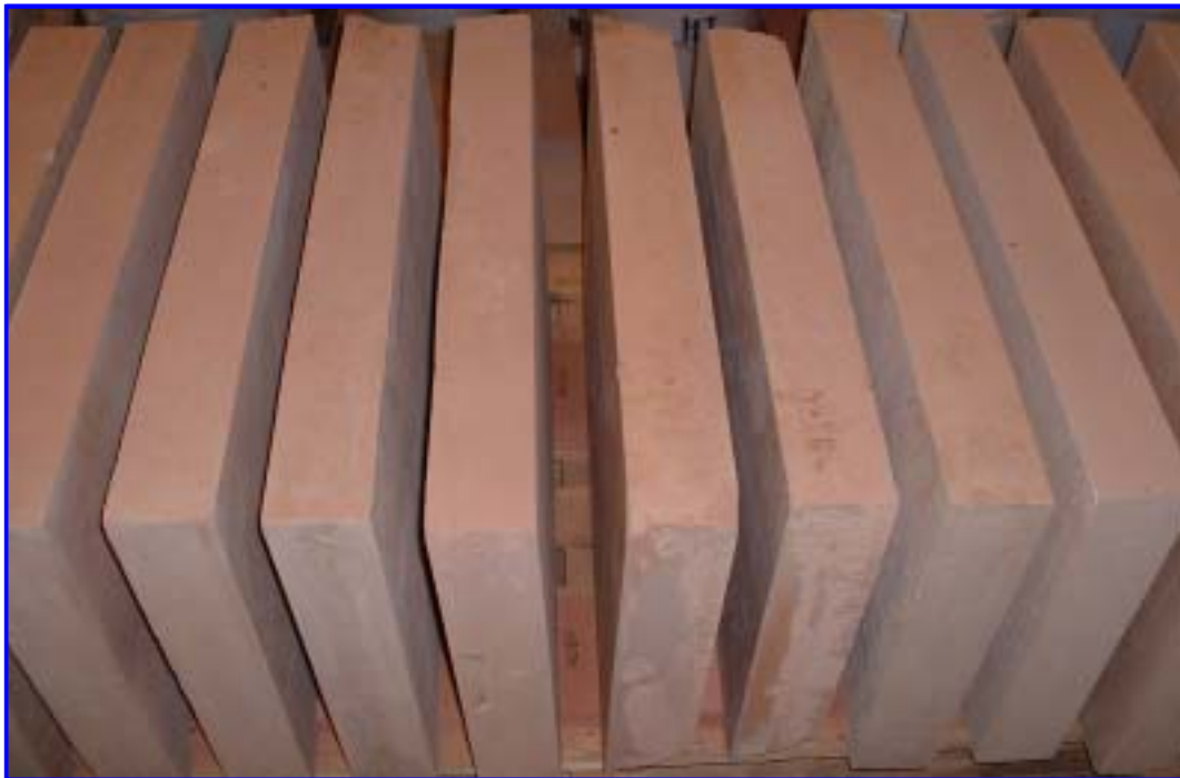
사진 14. 750× 500× 80mm 황토발포 PLATE 시험체 경화 및 건조
