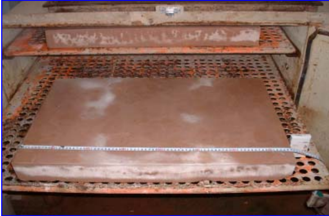
사진 13. 750× 500× 80mm 황토발포 PLATE 시험체 FUME 양생(80℃, 48hr)
