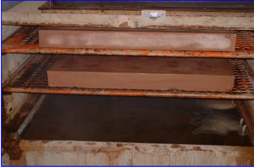
사진 11. 750×500×80mm 황토발포 PLATE 시험체 FUME 양생(80℃, 48hr)
