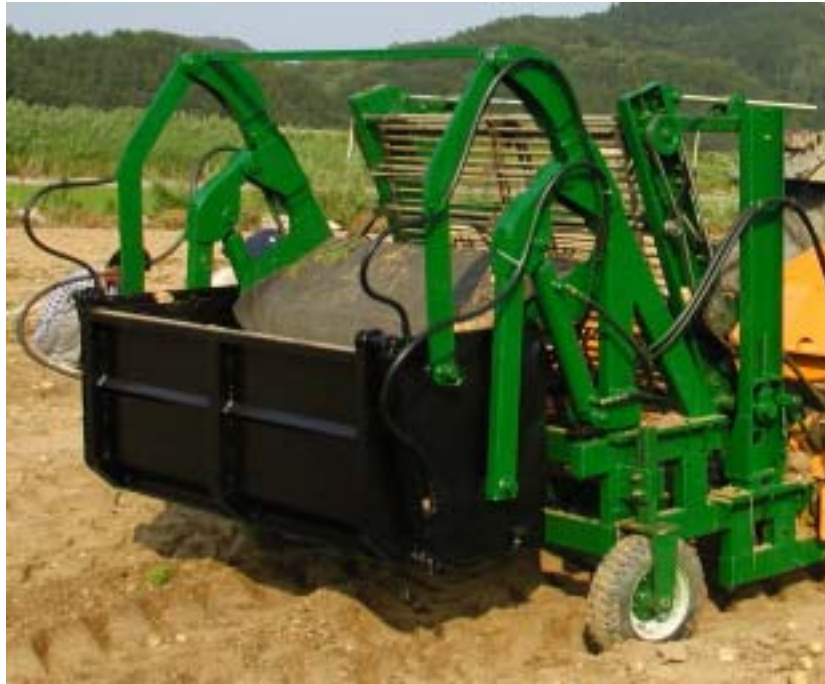
그림 4-9 감자 수집 및 배출 장치
