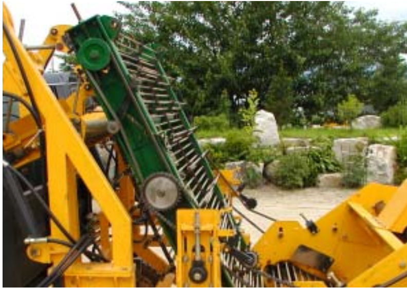
그림 4-5 돌출러그형 2차 컨베이어 이송장치
