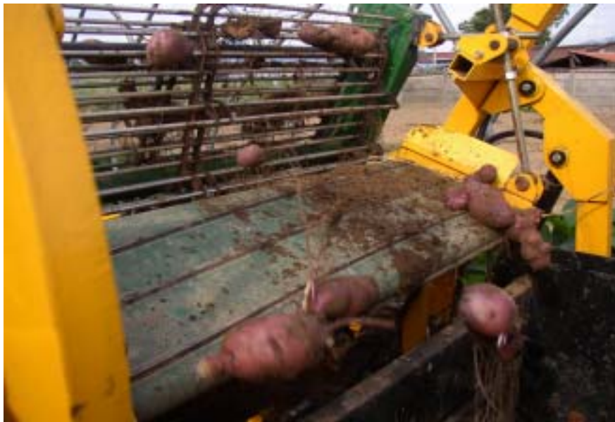
② 역회전 컨베이어를 통해 흙 및 이물질이 제거되는 모습
