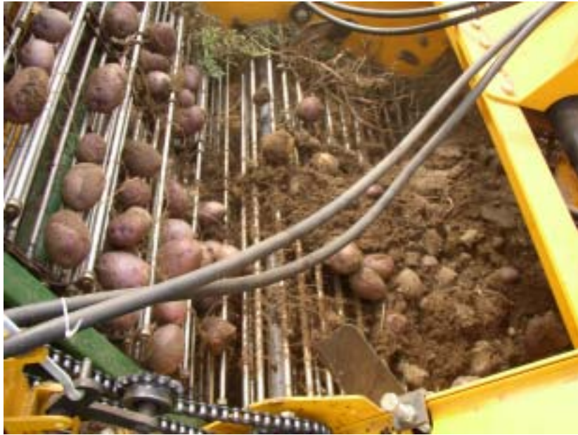
그림 5-5 굴취 및 1차 컨베이어 이송장치의 감자 이송 모습
