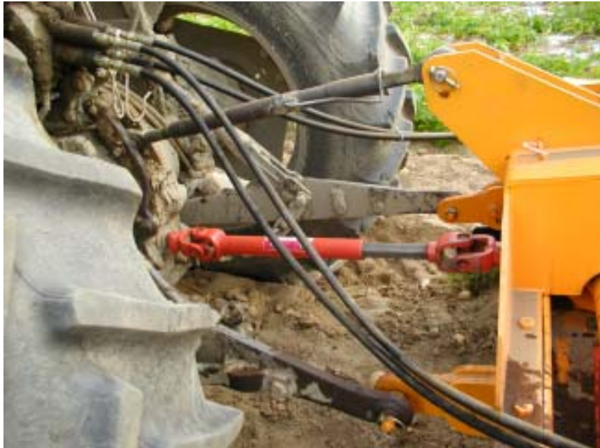
그림 4-12 3점링크 방식의 트랙터 조합 및 부착장치
