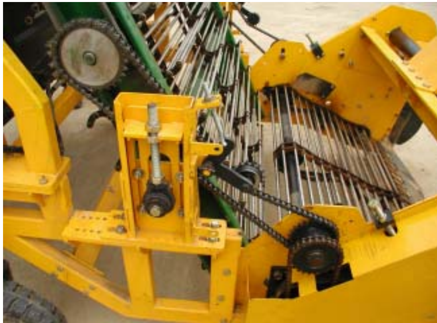
그림 4-3 1차 컨베이어 이송장치의 모습
