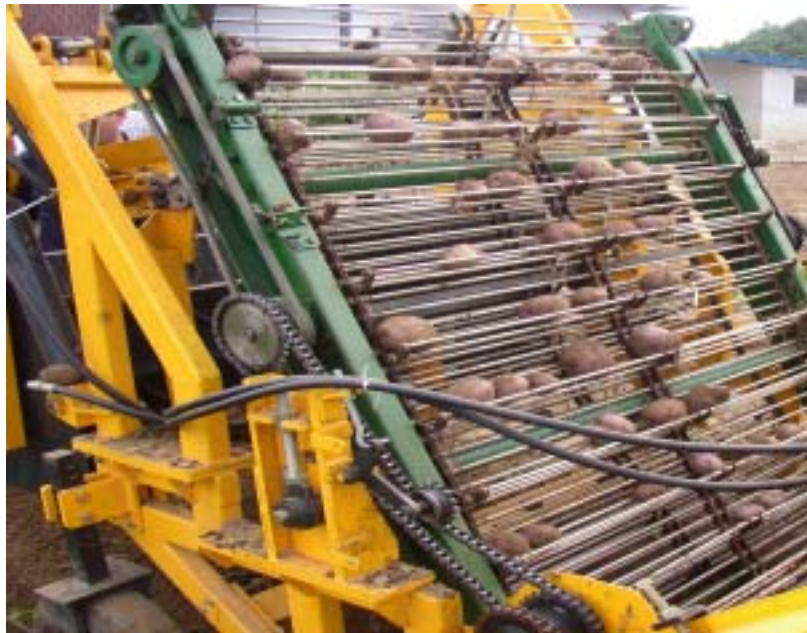
그림 5-6 2차 컨베이어 이송장치의 감자 이송 모습
