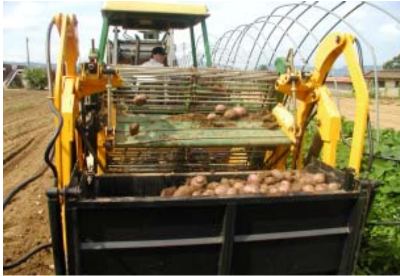
그림 5-7 2차 이송장치로부터 수집함에 수집되는 감자
