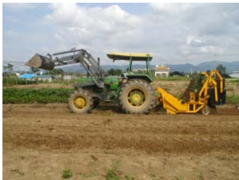
그림 5-3 트랙터에 장착된 통합시작기의 모습
