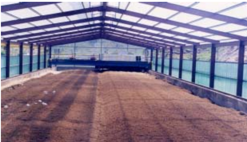
Fig. 4-16. 전처리 및 후처리 살수여상조의 교반과정
