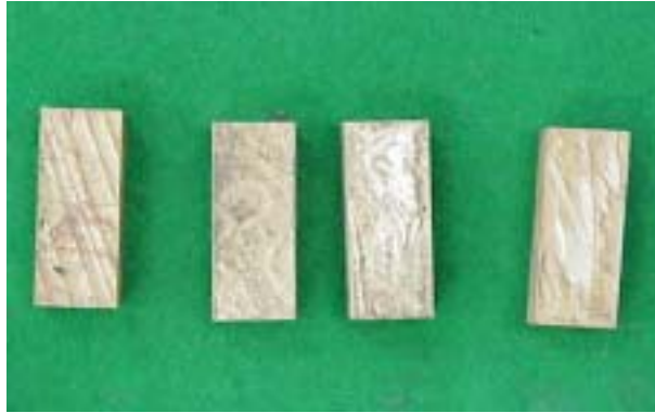
Fig. 3-4. 목편담체의 압축강도 시험편.
