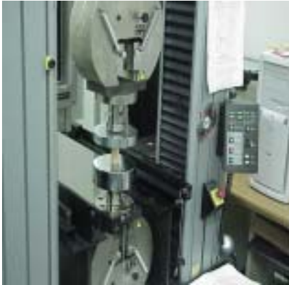
Fig. 3-5. 만능재료시험기와 압축강도 시험장면.
