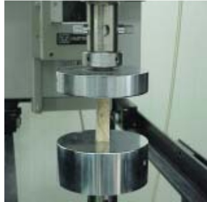
Fig. 3-5. 만능재료시험기와 압축강도 시험장면.
