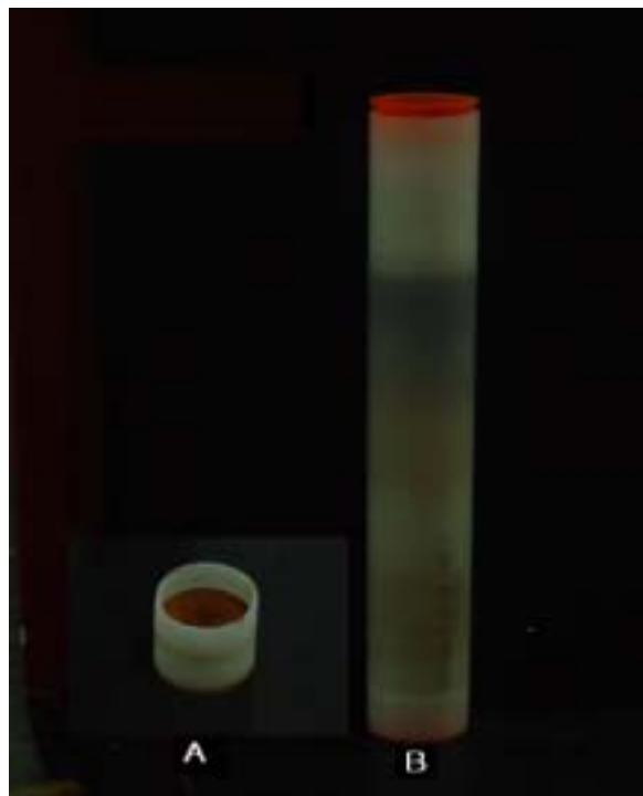
그림 2-16. 시료충진 flash chromatography column (A: 시료가 충전된 samplet, B: 분리용 column)
