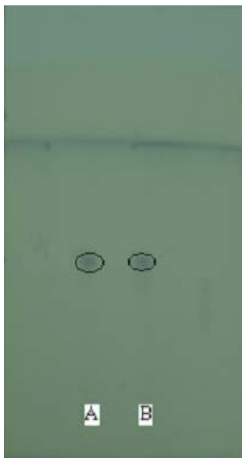
그림 2-37. 분리정제된 ferulic acid(A)와 표준품(B)의 TLC비교 (용매조건: 100% EtOAc)
