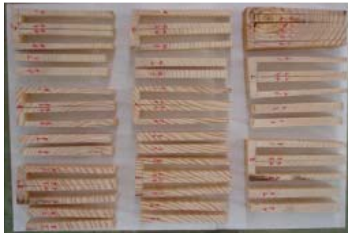
그림 36. 두께 25mm와 50mm 국산 소나무의 건조응력 측정을 위한 prong-test 후 모습.
