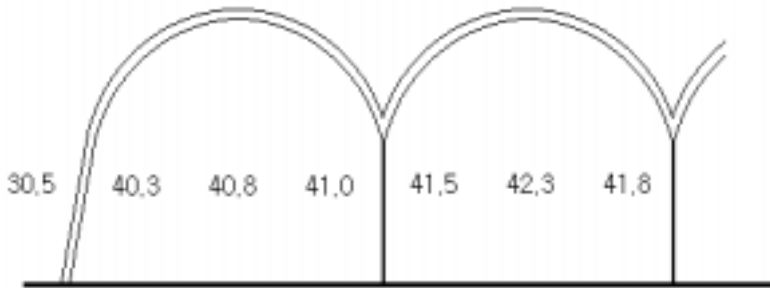
그림 22. 비차광 및 환기창 개방에 따른 온실 내·외부 기온분포도(전남 영암)
