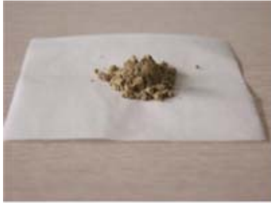
그림 34 (a). 제조된 PVP-Ag 분말 시료 (Ag 50-70wt% 함유)
