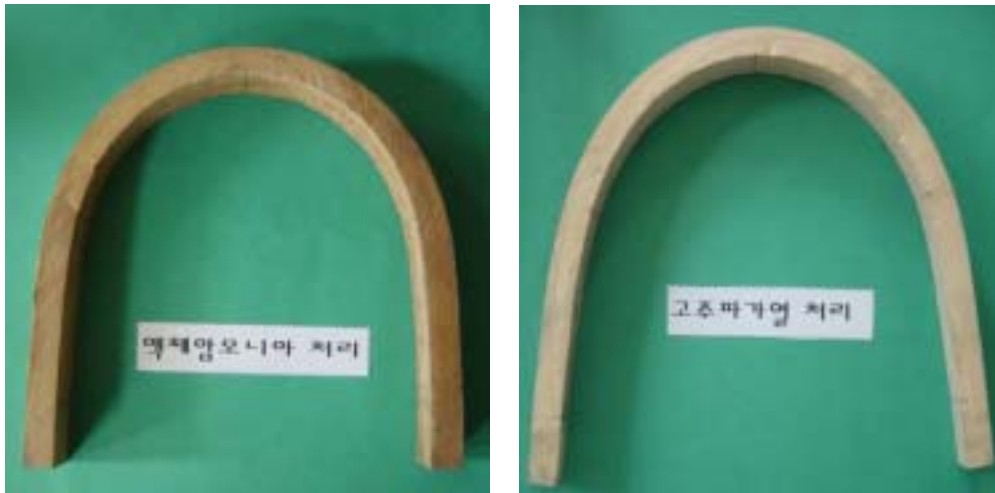
소나무 휨가공재의 암모니아처리(좌) 및 고주파처리(우)시의 형상 비교
