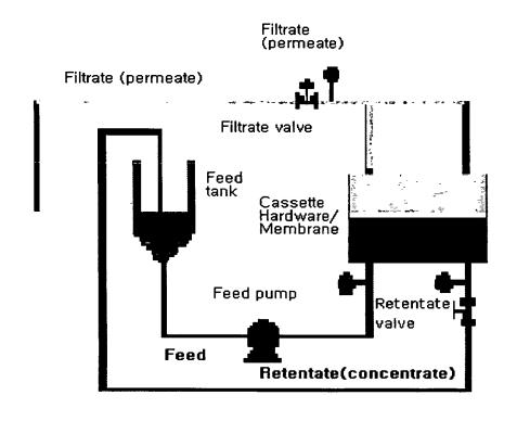
그림 23. Flow diagram of ultrafiltration system
