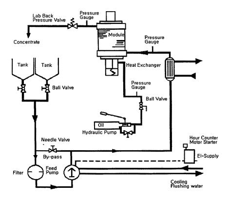
그림 24. Flow diagram of reverse osmosis system
