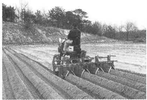
그림 2-3. 트랙터용 두둑성형기 작업장면 그림 2-4. 승용관리기용 두둑성형기 작업장면
