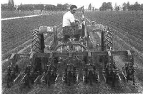
그림 3-5. 유럽의 트랙터용 중경제초기 ( Spring beet hoeing set )
