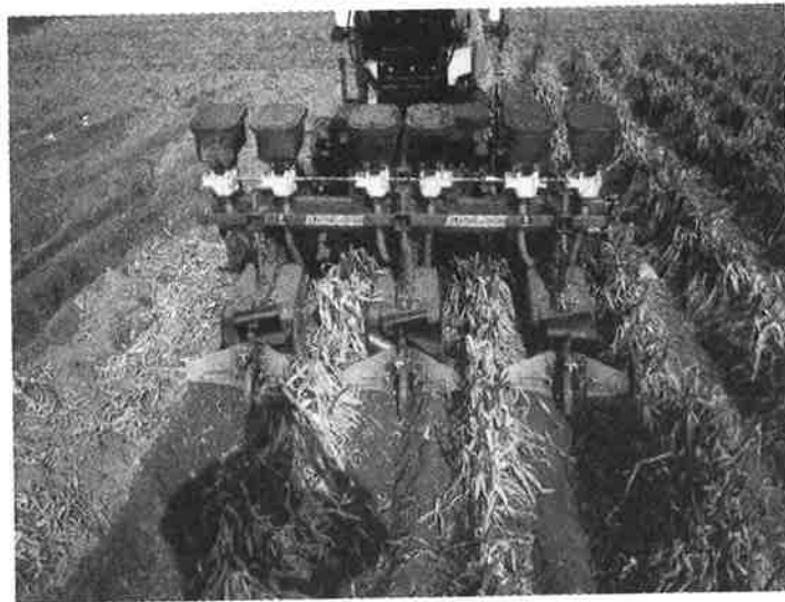
그림 3-24. 완성된 시작기의 2차 포장시험 장면 (시비장치, 배토기 부착)
