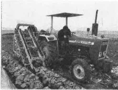
그림 5-11. 배추수확시험광경 및 작업정도(수확방식 : 원판절단날 + 경사벨트)
