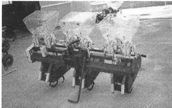
그림 3-2. 시비장치가 부착된 승용관리기용 로터리 컬티베이터(견본기)
