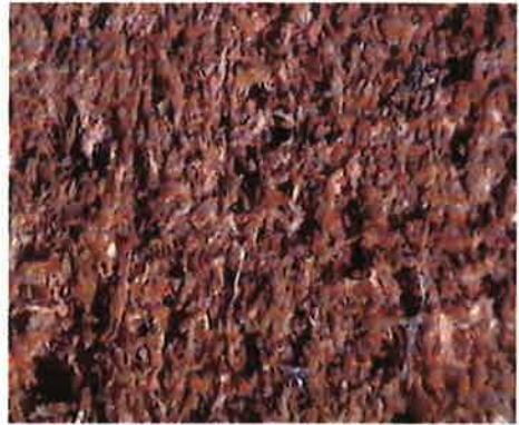
<사진 3-13> 폐목질·황토 분체복합보드의 표면(左側)과 내부파단면(右側) (×40)
