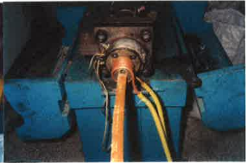
<사진 6-12> Sizing die에 의한 압출공정
