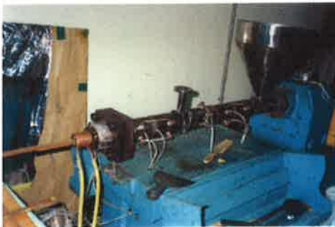
<사진 6-12> Sizing die에 의한 압출공정
