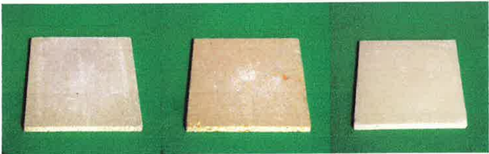
<사진 2-7> 클램핑 압체방식으로 제조한 목질·시멘트보드 (좌로부터 거친파티클, 미세파티클, 폐지섬유 사용)
