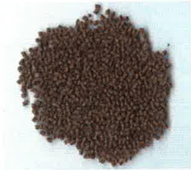
<사진 6-8> 분쇄 목분을 이용한 목분 · PP복합 펠렛
