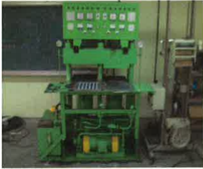
<사진 6-15> 시각장애인 인도용 보드를 제조하기 위한 프레스 및 금형
