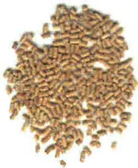
<사진 6-7> 연삭 목분을 이용한 목분 · PP복합펠렛
