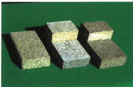
<사진 2-20> 야외폭로처리 24개월 경과 후 목질·시멘트블럭의 표면 및 단면상태 (左 : 실내, 中 : 옥상, 右 : 地中)
