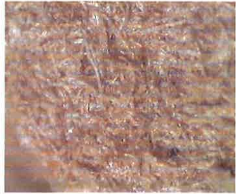
<사진 3-12> 폐MDF분체복합보드의 표면(左側)과 내부파단면(右側) (×40)
