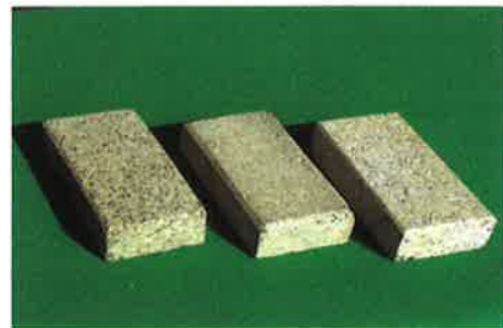
<사진 2-21> 야외폭로처리 24개월 경과 후 목질·시멘트블럭의 표면 연마상태 (左 : 실내, 中 : 옥상, 右 : 地中)
