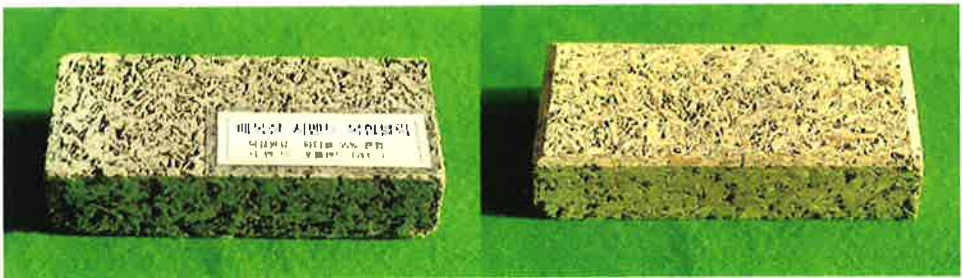
<사진 2-17> 목질·시멘트블럭 완성제품 (좌 : 표면연삭전, 우 : 표면연삭후)
