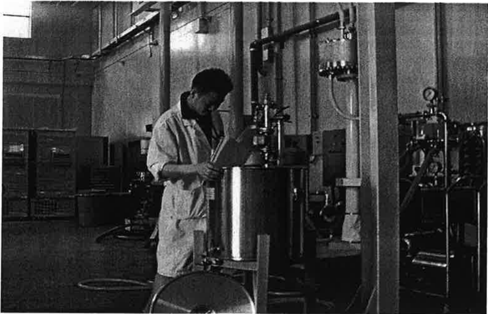
Fig.3-57 회분식 추출 장치에 의한 butanol 추출 작업
