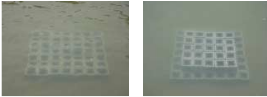
그림 3.4.5-3 돌망태 어초 파랑시험 후의 모습
