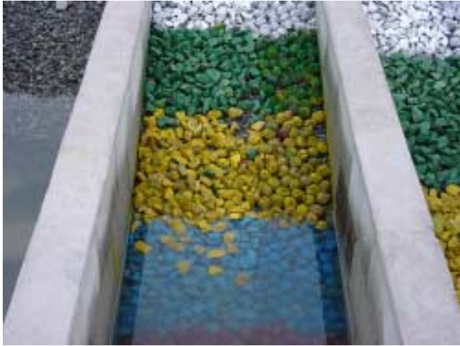
그림 3.3.2-5 유실된 방파제 사면(파고 7m, 주기 11sec, 만조위)
