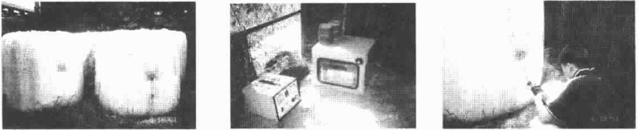
그림 2-39 온도와 pH의 연속적인 측정을 위한 장치의 설치 장면
