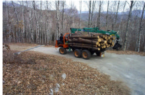
그림 5-10. 콘크리트 임도 주행테스트광경
