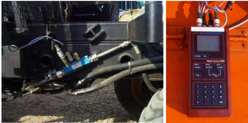
그림 5-3. 센서 부착위치 및 유압계측 데이터로거 사진
