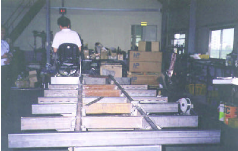
그림 2-12. 기본차량의 후면 적재함 프레임
