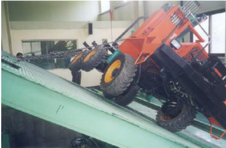
그림 4-54. 정지 횡전도각의 측정 장면
