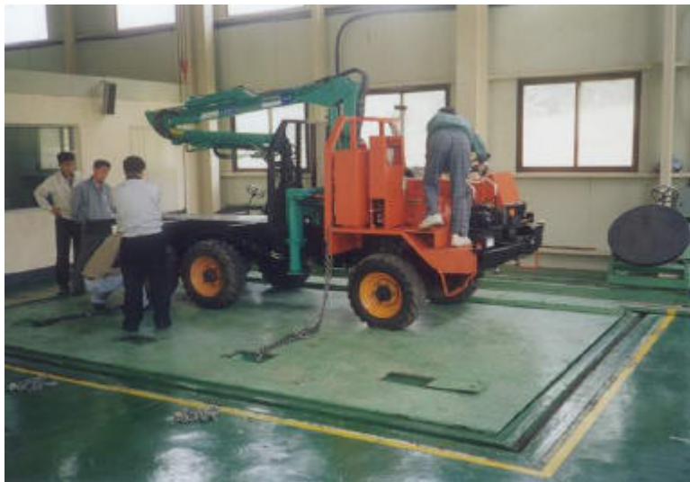
그림 4-53. 정지 횡전도각을 측정하기 위한 장치 구성
