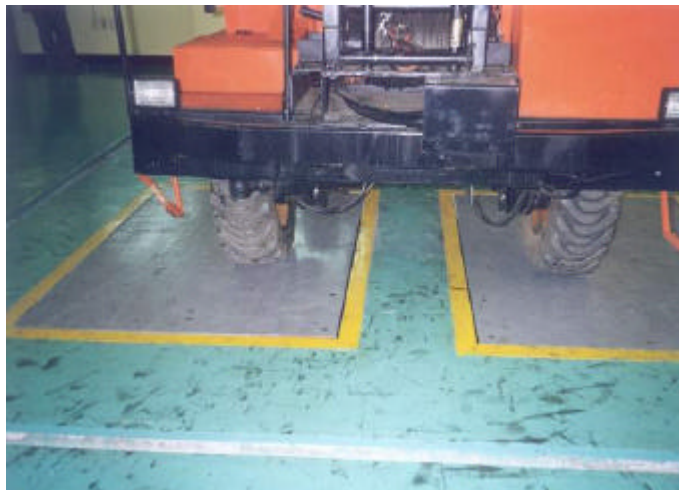
그림 4-18. 전륜에 작용하는 하중 측정
