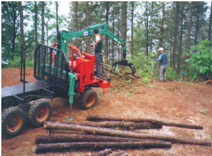
그림 5-21. 원치에 의한 집재작업 광경 (임도변)
