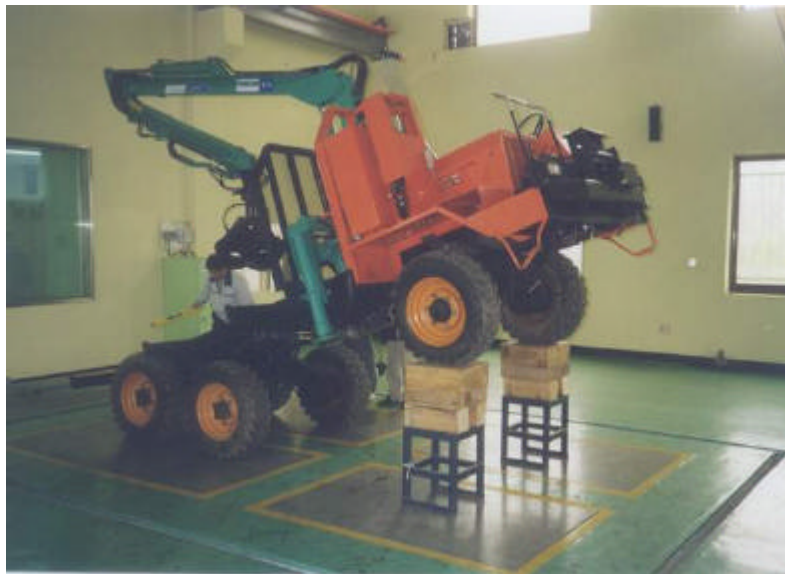
그림 4-20. 보기 차륜에 작용하는 하중 측정
