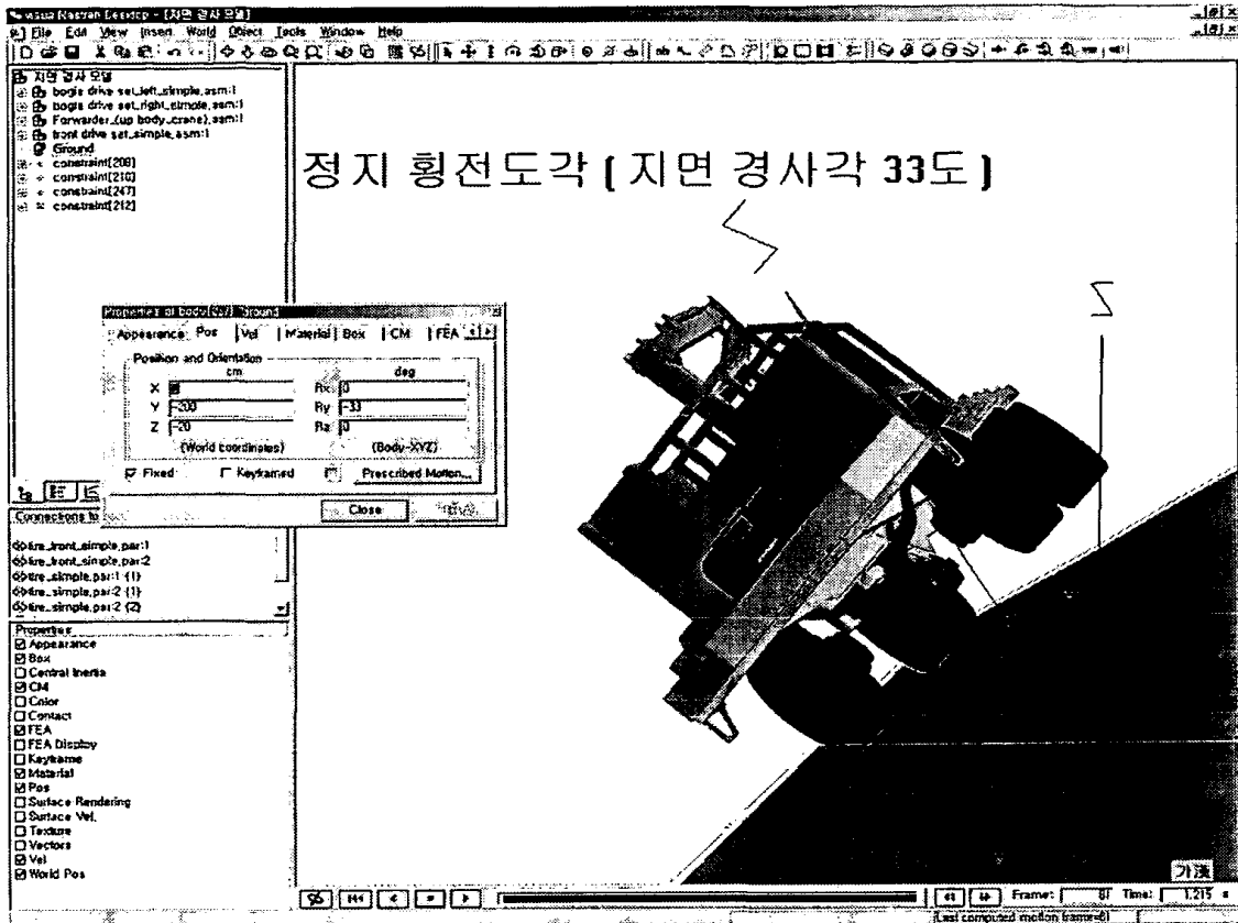
그림 4-55. 횡전도 시뮬레이션을 이용한 포워더의 정지 횡전도각의 예측
