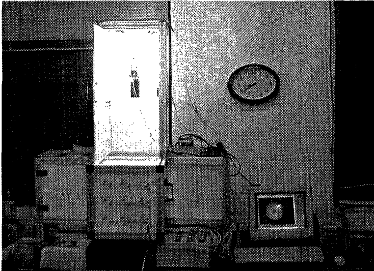
그림 2-2. 정지 영상 획득용 기계시각 장치
