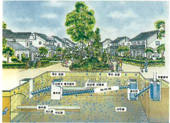
〈그림 5-14〉 지하우수의 저류 시스템
