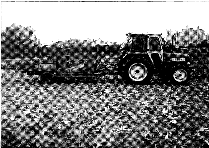
그림 5-13 개량 제작된 채소 잔유물 현장 수거기의 모습
