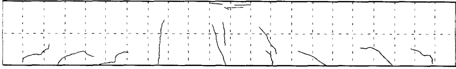
c. 보강시험체(t-3)의 균열 양상
