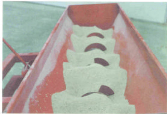
그림 7. 복토리파기의 울퉁조형장치 내부구조
