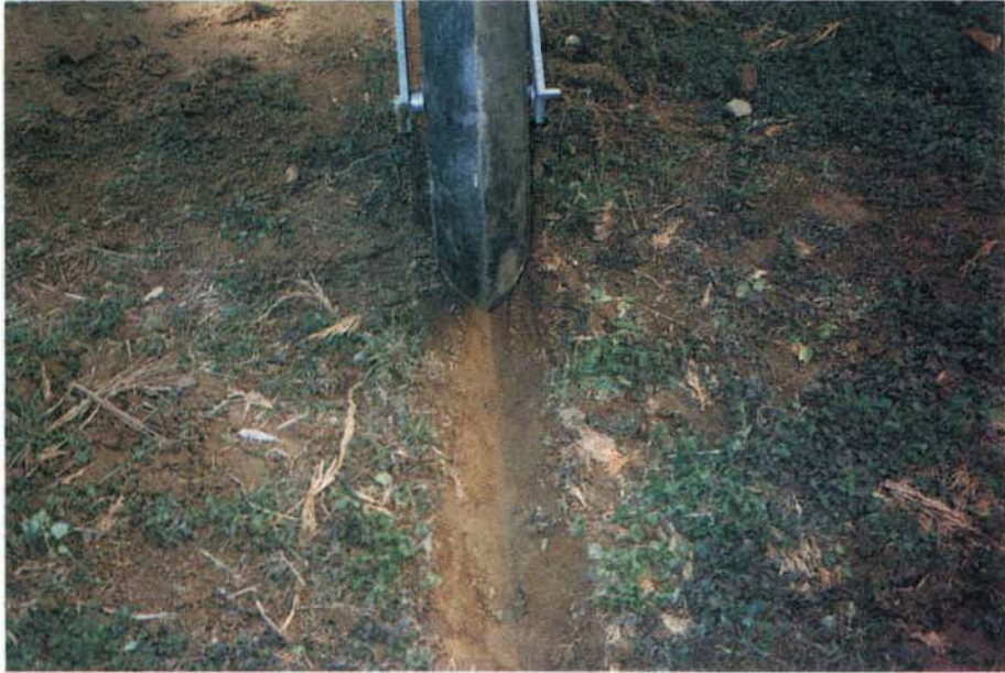
그림 6-16. 주행방향을 안내하는 안내바퀴의 V형 고랑
