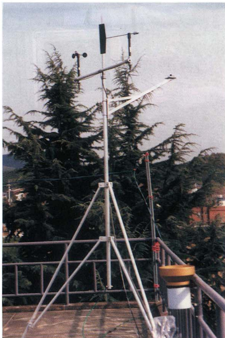
그림 6-6. 기지부 근처 포장기준 높이 Z=15\text{m} 에 설치된 기상센서(고도 55m).
