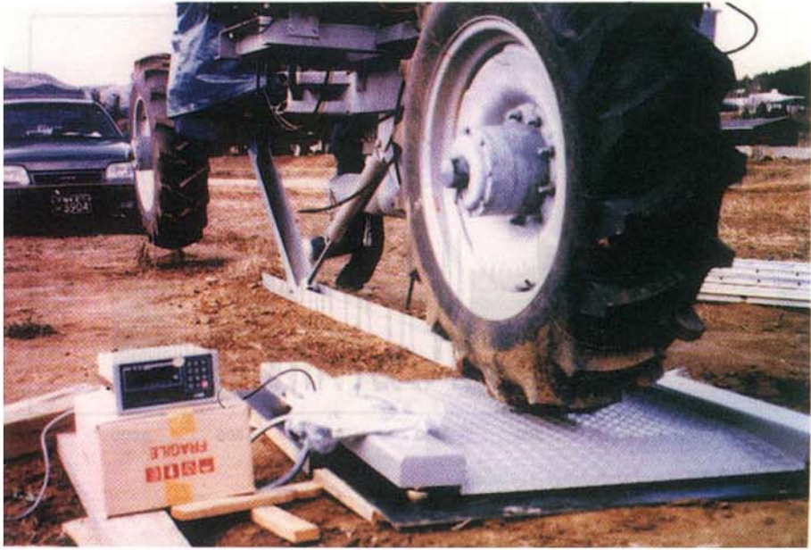
그림 5-7. 구동부 해석을 위한 바퀴의 수직하중 측정
