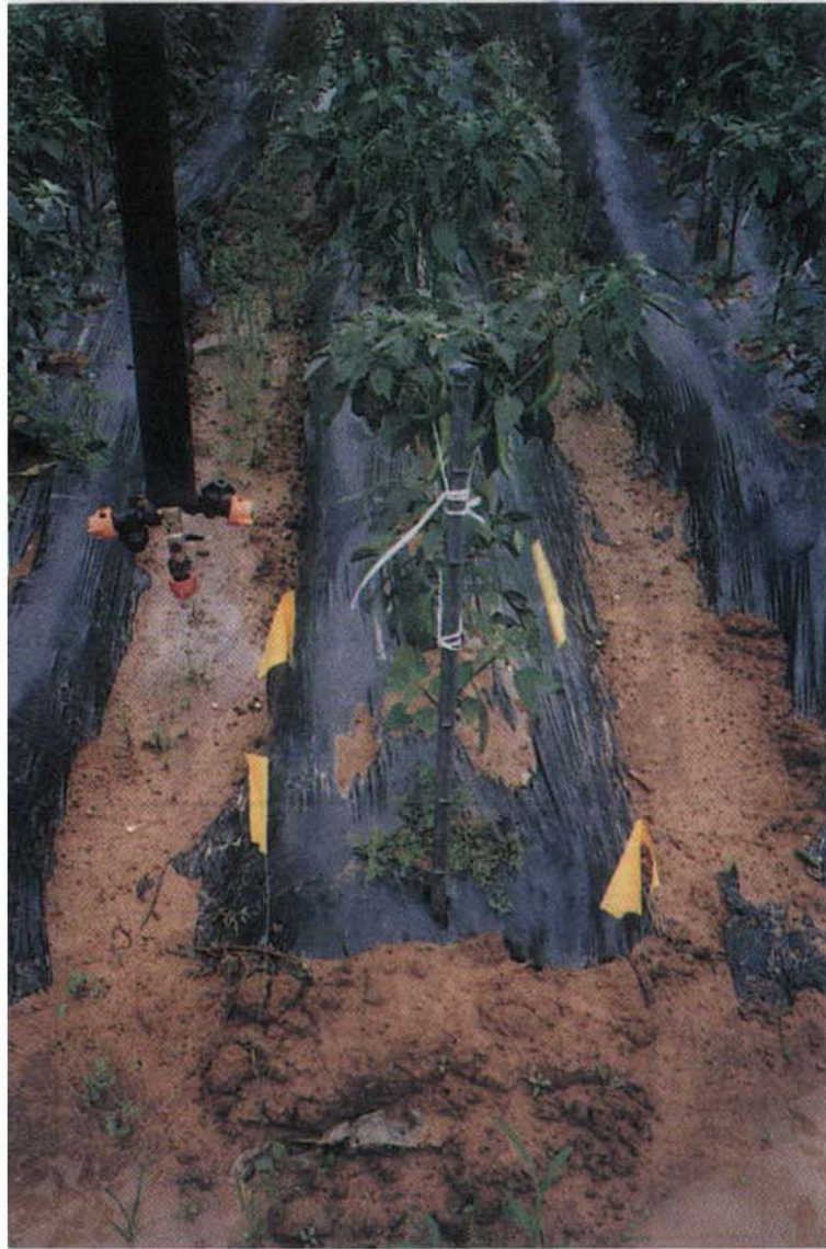
그림 6-8. 고추밭에 30과 60 cm 깊이에 토양수분센서를 장치하고 표시한 모양
