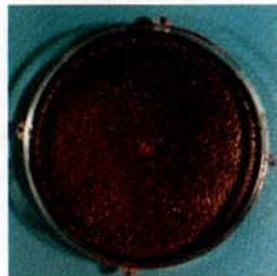
사진 17. 균( A. oryzae )접종 시료 (PF-HCl blood glue + 5% 보존제)
