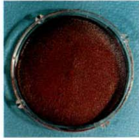
사진 15. 균( A. oryzae )접종 시료 (PF-HCl resin)
