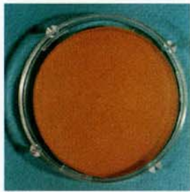
사진 9. 균( A. oryzae )접종 시료 (순수 Blood glue-HCl)
