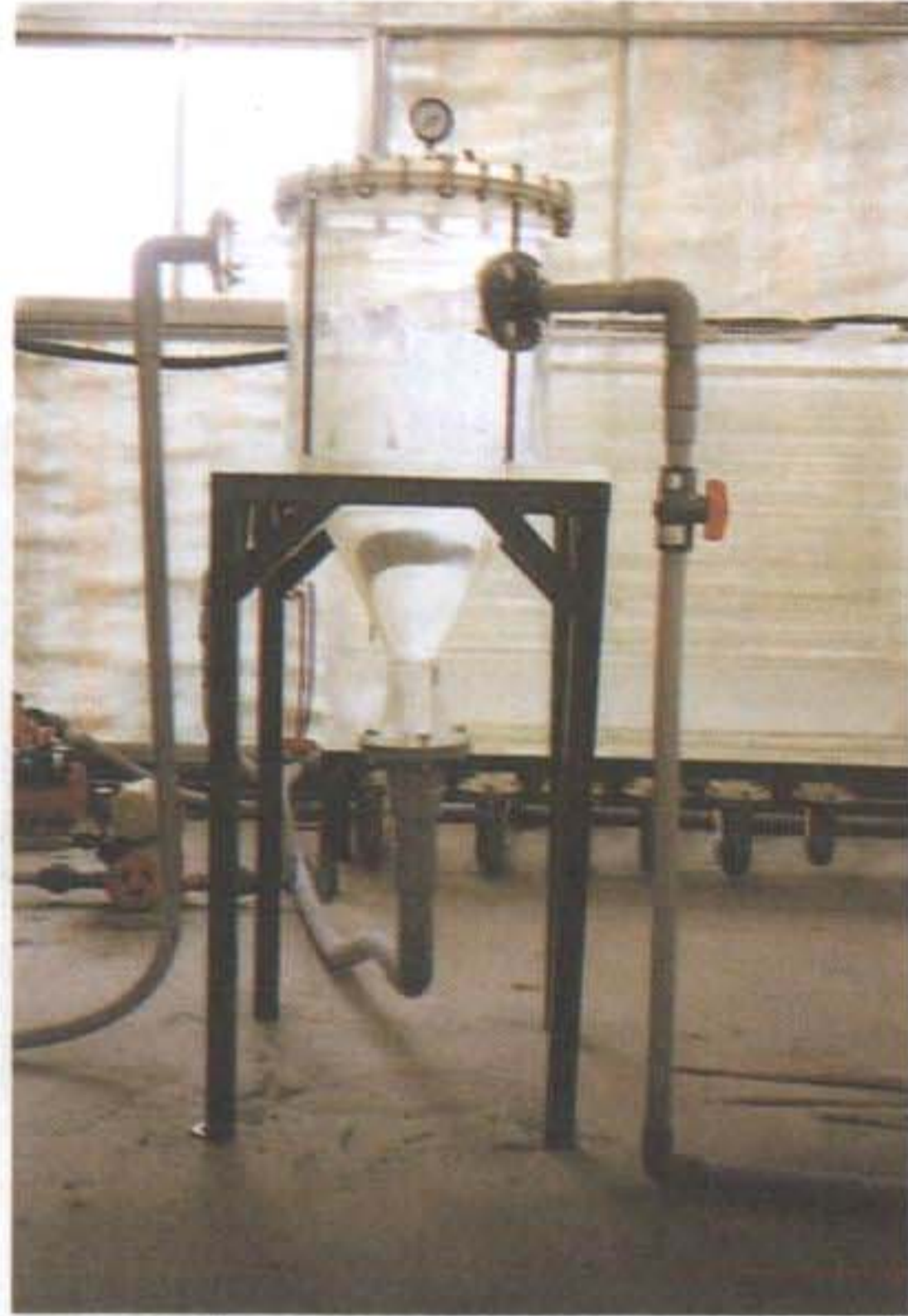
<그림 3-4-8> Hydroclone 형 노폐물 배출장치
