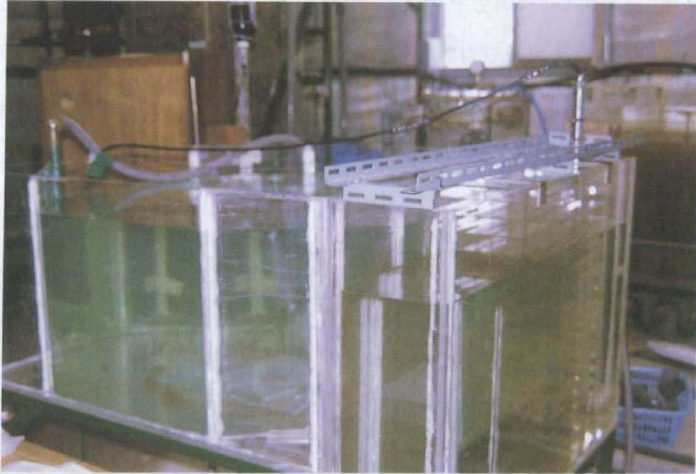
<그림 3-5-2> 모형수조의 형상(좌측 : 사육조부분, 우측 : 침전조부분)
