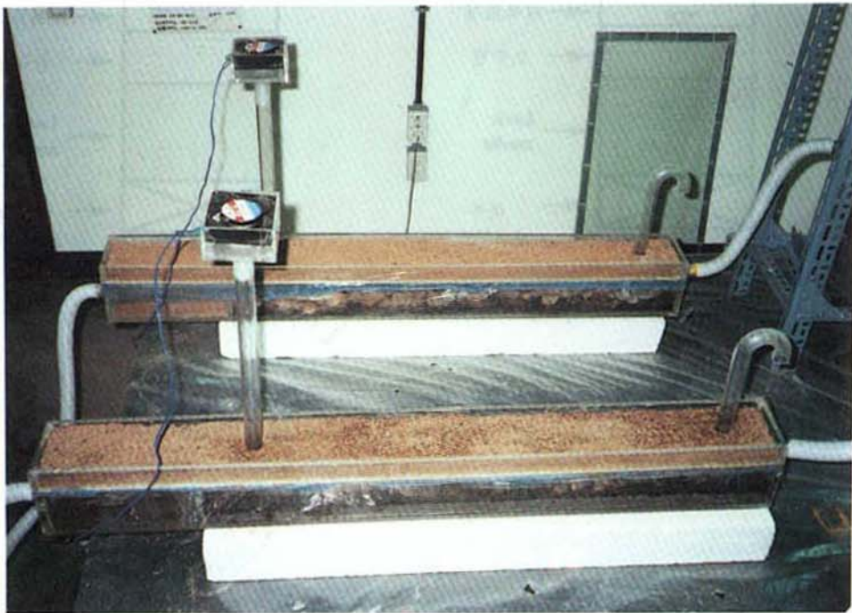
그림 3-4-2-7 모형 토양필터 실상도(lab scale)
