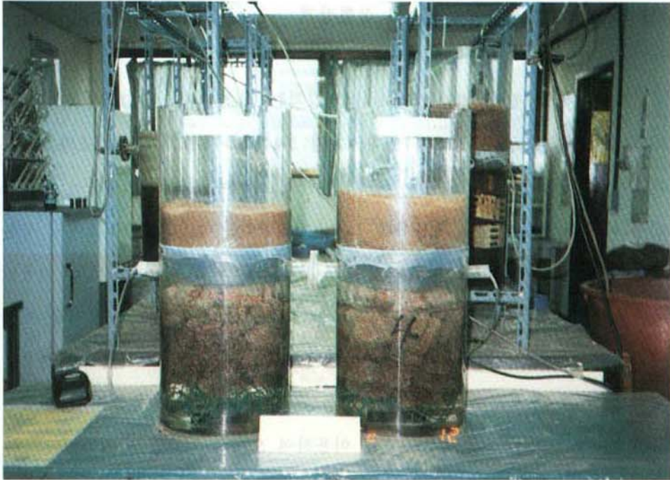
그림 3-4-2-9 Z균-Compost 대체물질 실험장치 실상도(lab scale)
