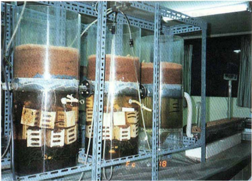
그림 3-4-2-4 상자형 kureharon lock 여재충진 실상도 (lab scale)
