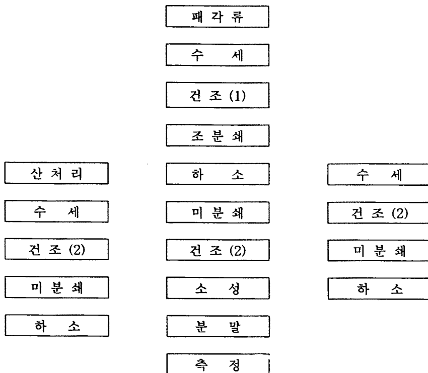
Fig.1. 굴 패각의 소성가공 및 분말화의 Flow Chart.
