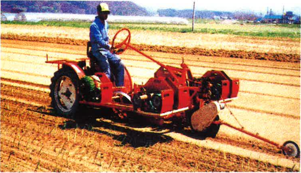
<사진 4-9> 자주식 자동 양파 이식기에 의한 양파 이식
