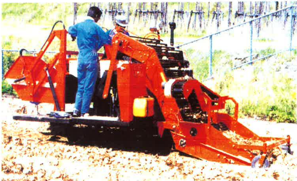
<그림 4-4> 자주식 감자 수집기(수집, 분리선별)에 의한 감자 수확
