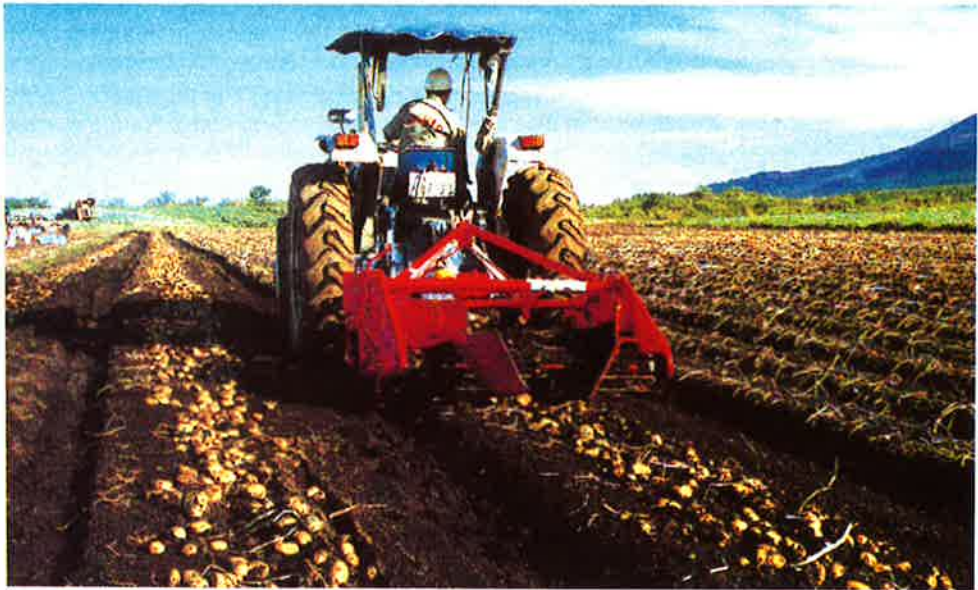
<사진 4-3> 트랙터 부착용 감자 굴취기에 의한 감자 수확
