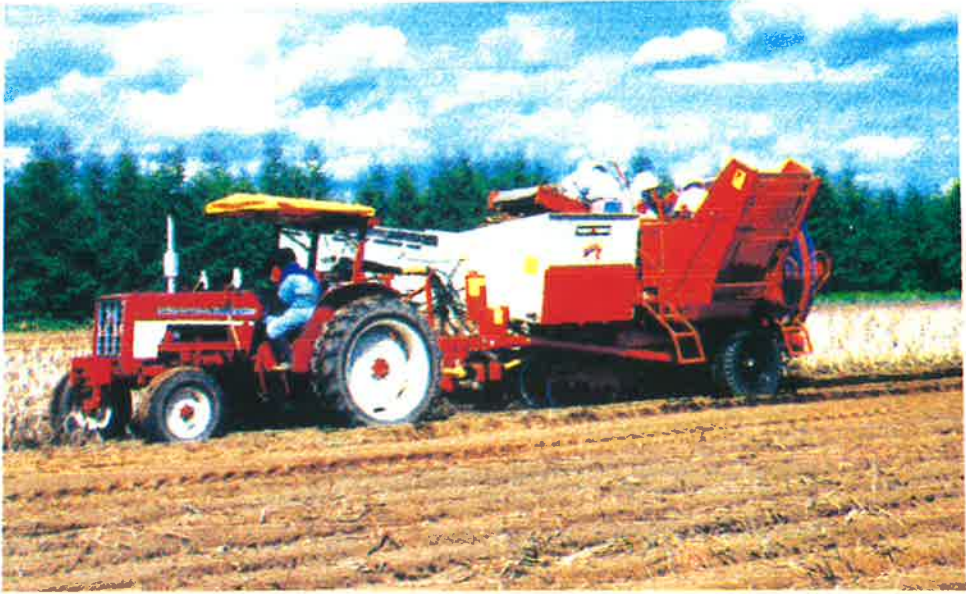
<사진 4-7> 감자 수확기(굴취, 분리선별)에 의한 감자수확
