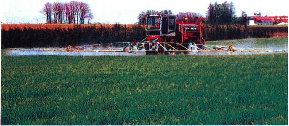
<사진 4-13> 자주식 붐 스프레이어에 의한 약제 살포
