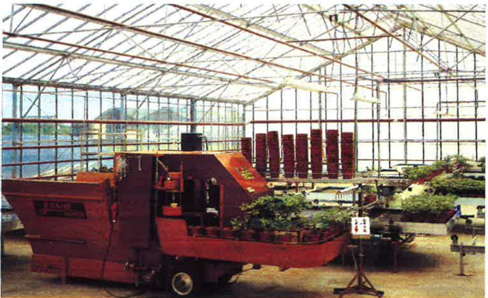
<사진 4-31> 화분의 자동 상토 충전기
