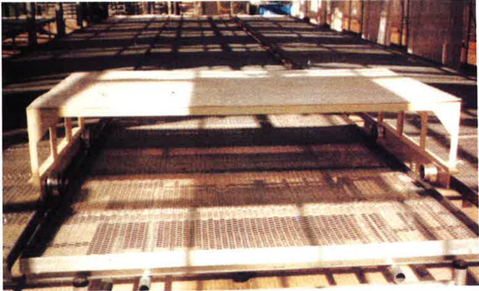
<사진 4-23> 유묘 공장의 트레이 이송 시스템
