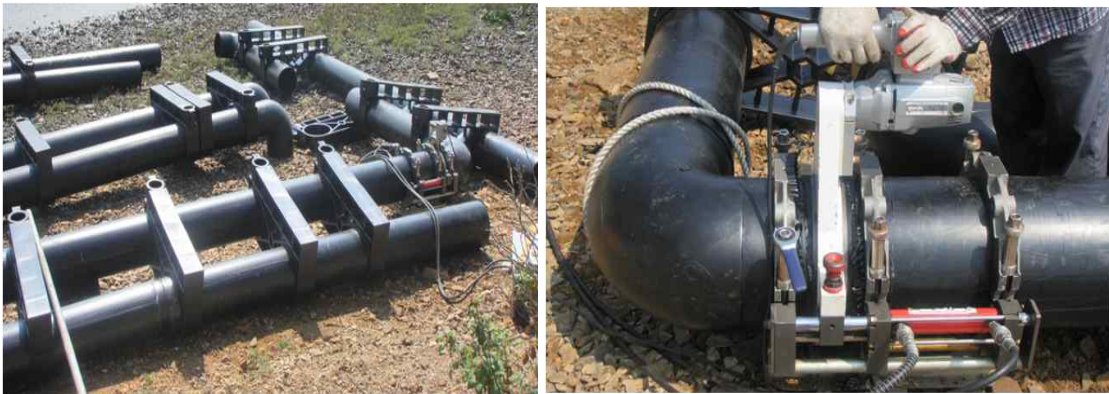
그림 3-4-3. 해면 중간 육성가두리(PE 파이프 열가열 용착(2011.9.01.))
