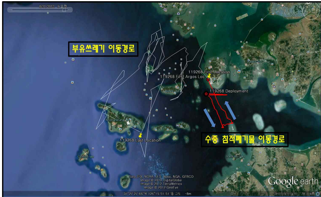
인천광역시 주변해역 - Pop-Up Tag 부착 어구의 해수 중 이동경로 및 해수면으로 부상한 Tag의 이동경로
