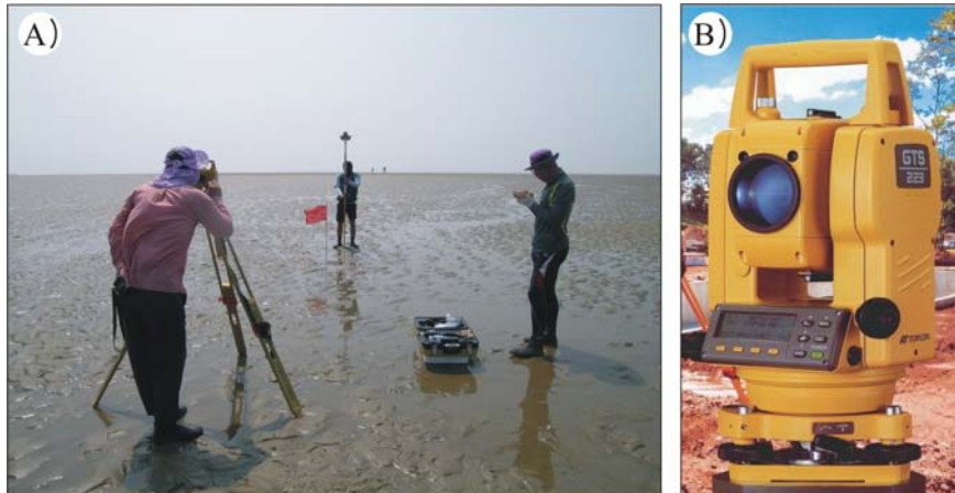
[그림 1-12] 수준측량 전경(A) 및 측량에 사용한 토탈스테이션 (Topcon GTS-225) (B)
