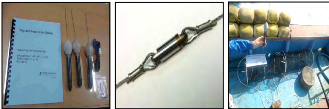
<그림 5.2> 침적폐기물 추적 장비 - 위성추적장치 Pop-Up Tag
