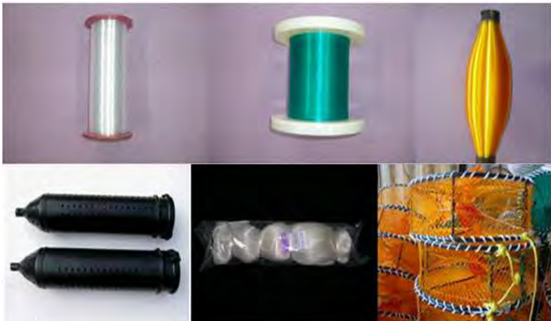
<그림 4.72> 생분해성 어구 소재 및 종류 (上 : 모노필라멘트, 下 : (왼쪽부터) 붕장어 통발, 대게자망, 그물통발)
