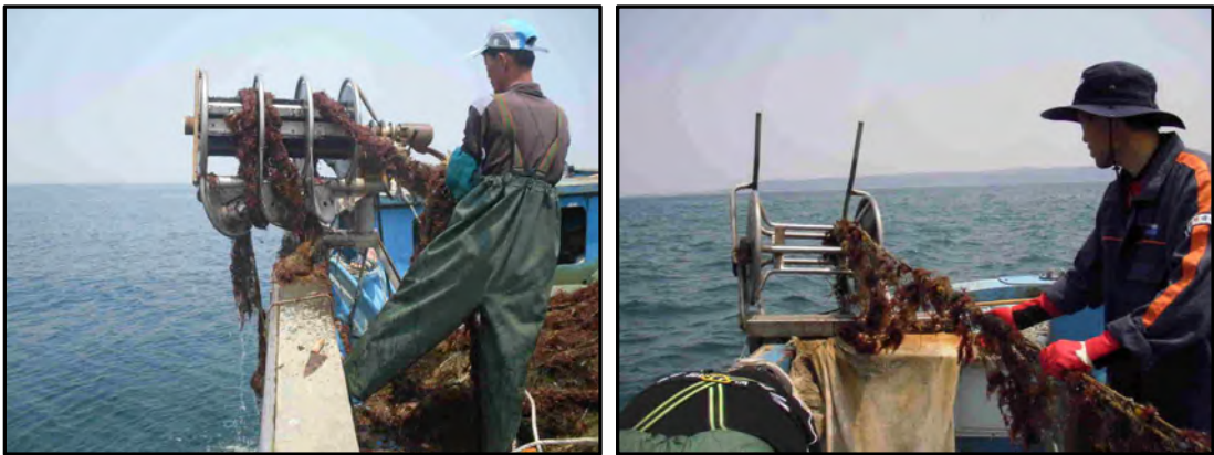
<그림 3.3> 인양틀에 견인된 수중 침적폐기물의 인양작업
