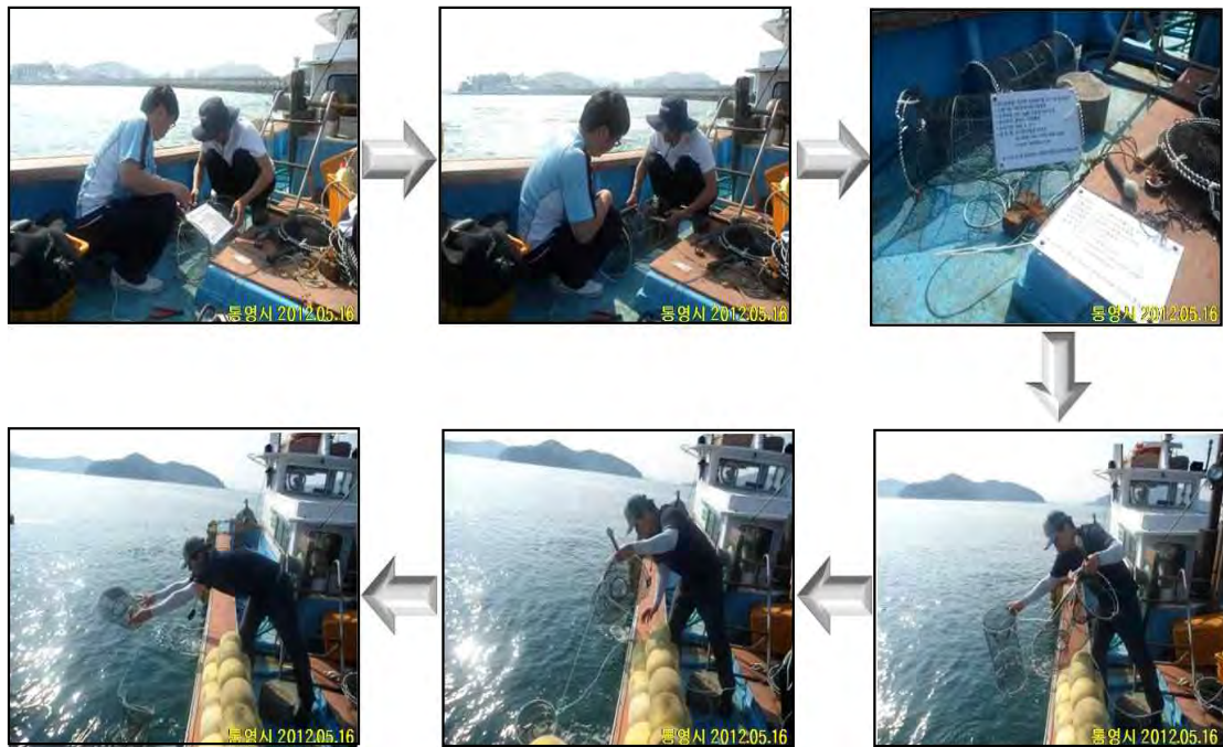
<그림 5.16> 통영시 주변해역 어구 이동경로 조사 - Pop-Up Tag 부착 어구 투하
