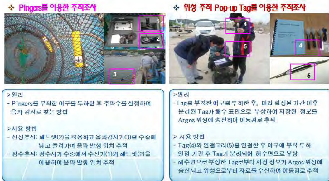
<그림 6.1> Pingers와 Pop-Up Tag를 이용한 어구 추적
