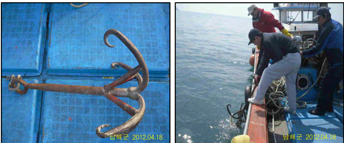
<그림 3.45> 남해군 미조면 마안도 ~ 창선면 가인리 해역에 사용된 인양틀과 작업사진
