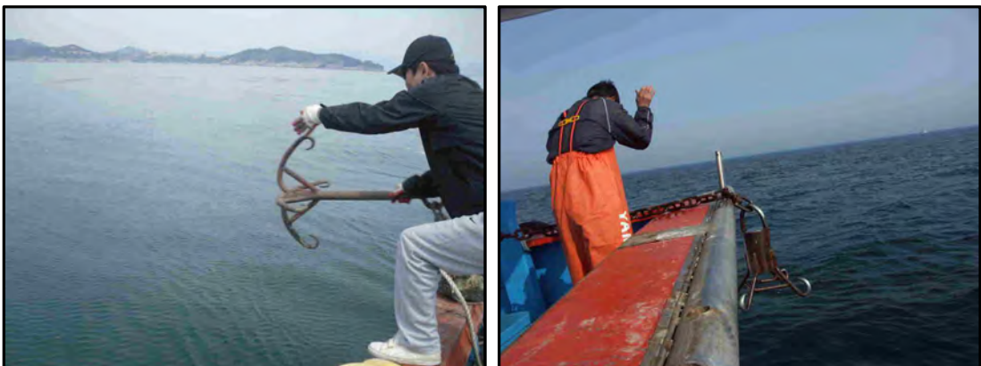
<그림 3.2> 인양틀 투하 및 회수작업
