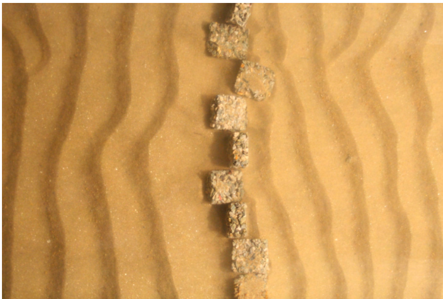
그림 3-3-41. 기존 다공질 갯벌둑 실험장면-2(h=1.8m)
