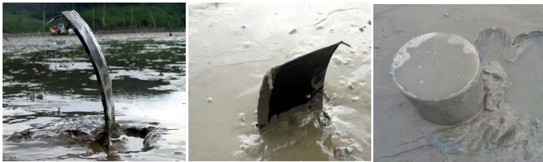
그림 3-4-16. 1/4로 절단된 PE관, 시험포 설치 장소에서의 물 투수성 실험
