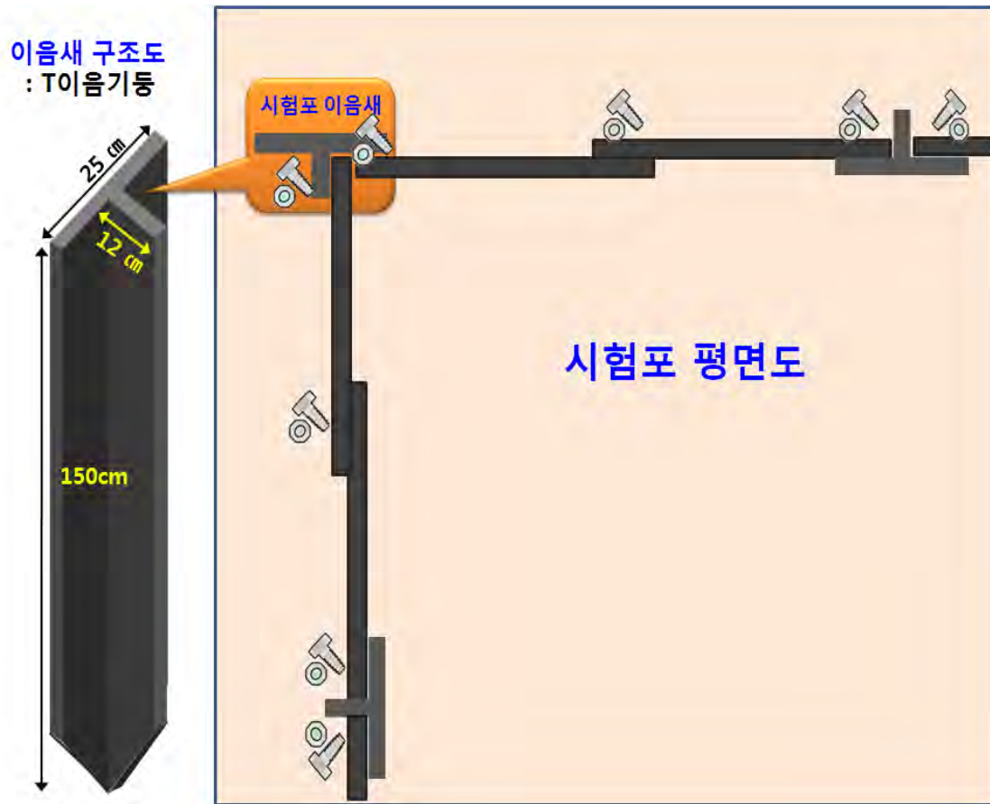
그림 3-4-29. T이음기둥 설치 및 계획도
