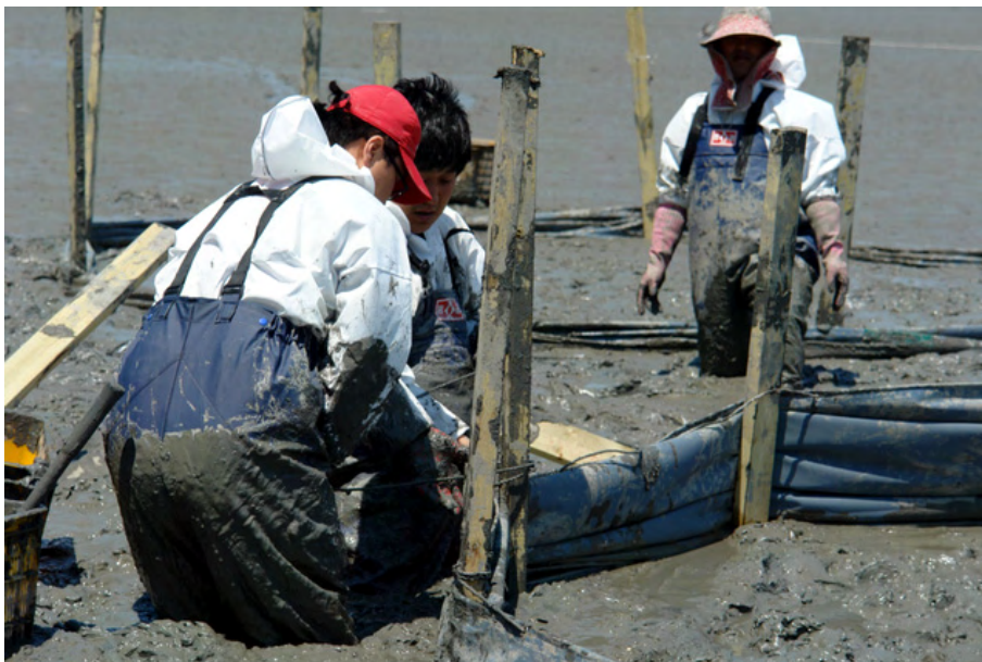
그림 3-4-34. 방수천을 이용한 소규모 시험포 설치
