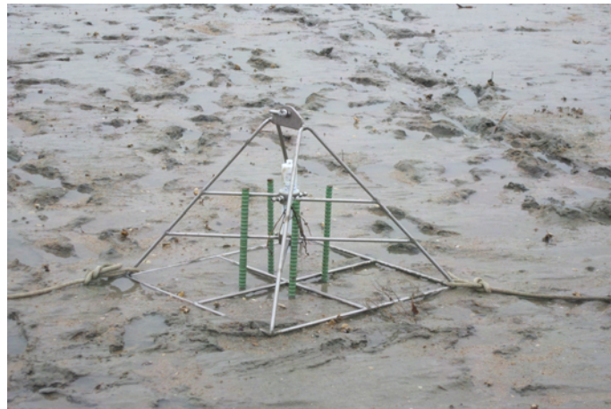
그림 3-2-28. 저조선에 설치한 파랑계(RBR-TWR)
