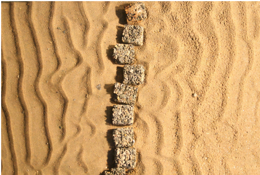
그림 3-3-39. 기존 다공질 갯벌둑 실험장면-2(h=0.3m)
