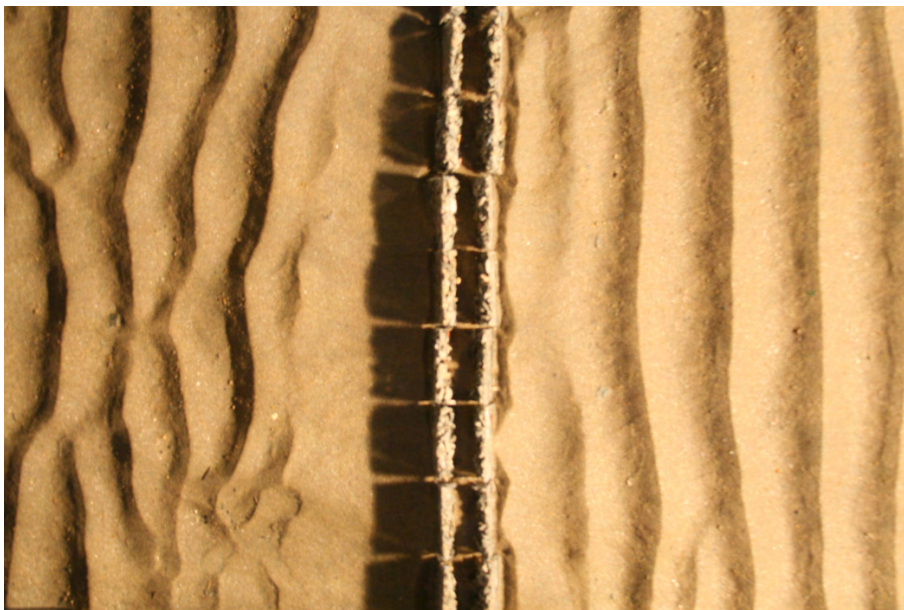
그림 3-3-49. 개선 다공질 갯벌둑 실험장면-2( h=3.33m )
