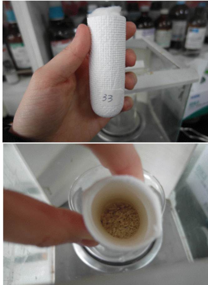
그림 3-5-10. 바지락 조지질 측정 중 Soxhlet 추출기에 장착할 원통여과지
