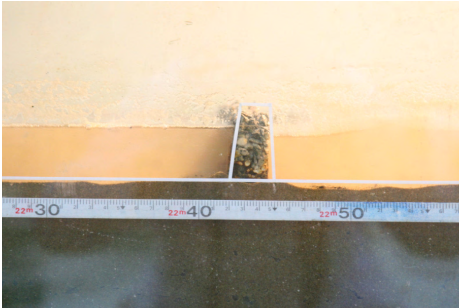
그림 3-3-42. 기존 다공질 갯벌둑 실험장면(h=3.33m)
