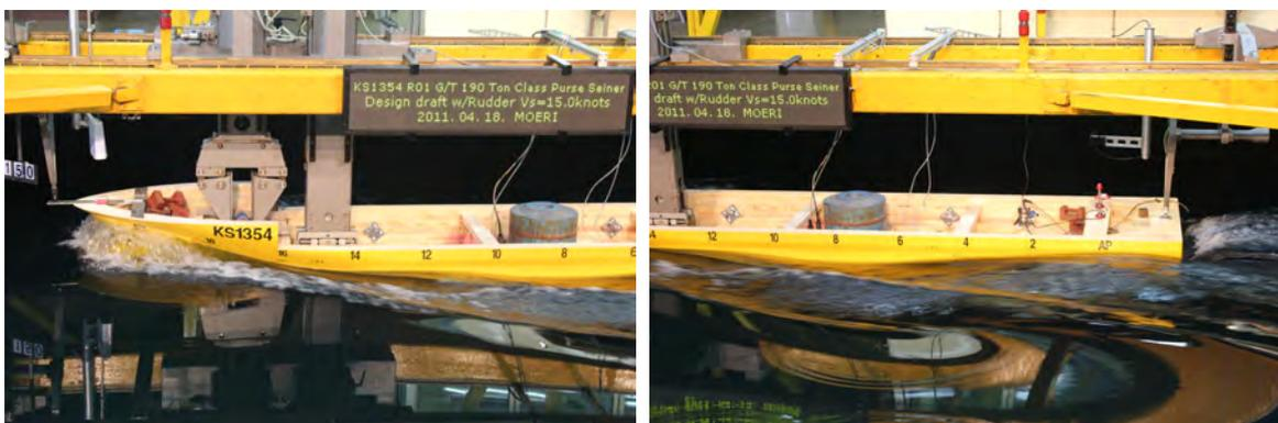
그림 3.1.28 Photographs of the Running Ship Model(KS1354, Design draft, 15.0 knots)
