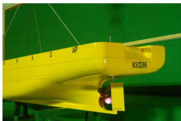
그림 3.1.16 모형선에 전체 부가물이 부착된 상태
