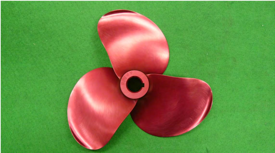
그림 3.3.28 KF-3-65-55( $AE/AO=0.65$ ,  $P/D=0.55$ ) Model Propeller (Pressure Side)
