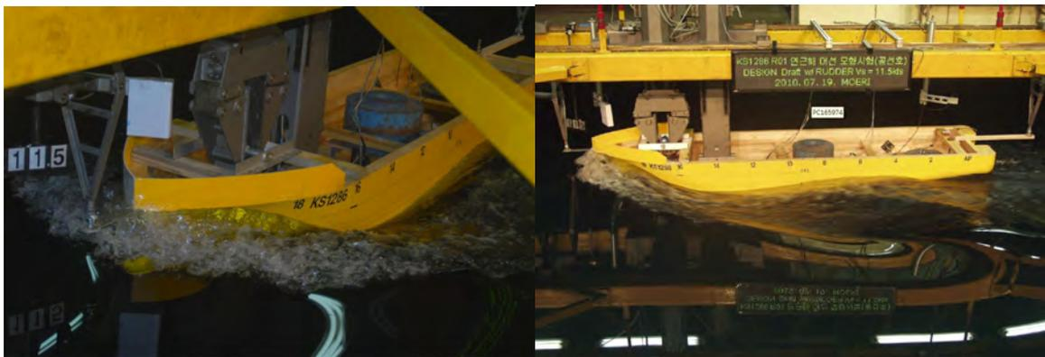
그림 3.1.19 Photographs of the Running Ship Model(KS1286, Design draft, 11.5 knots)
