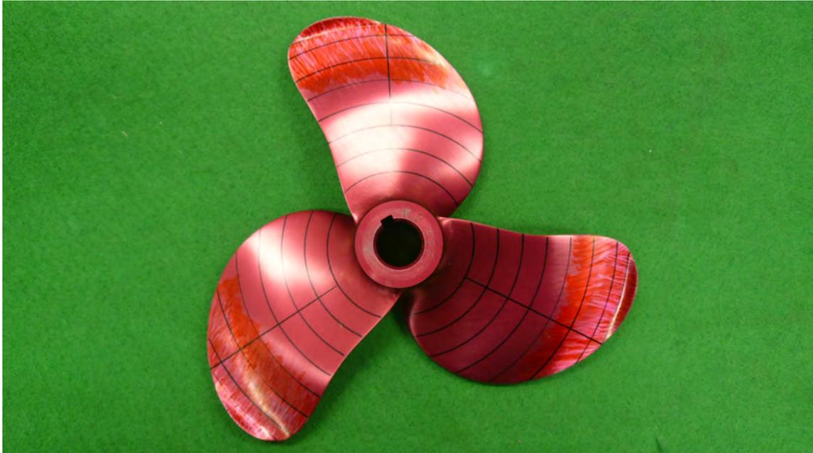
그림 3.3.25 KF-3-50-40( $AE/AO=0.50$ ,  $P/D=0.40$ ) Model Propeller (Pressure Side)
