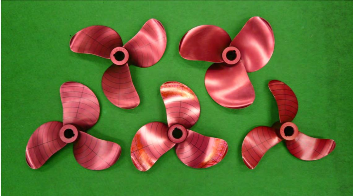
그림 3.3.23 5case model propellers for POW Test
