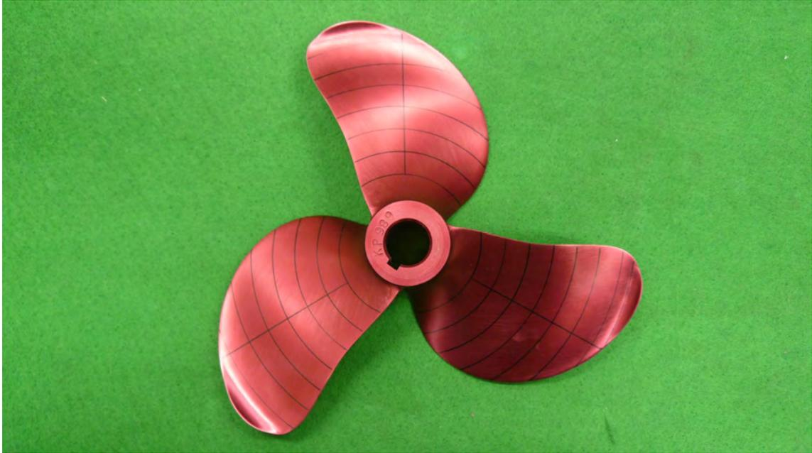
그림 3.3.27 KF-3-50-70( $AE/AO=0.50$ ,  $P/D=0.70$ ) Model Propeller (Pressure Side)
