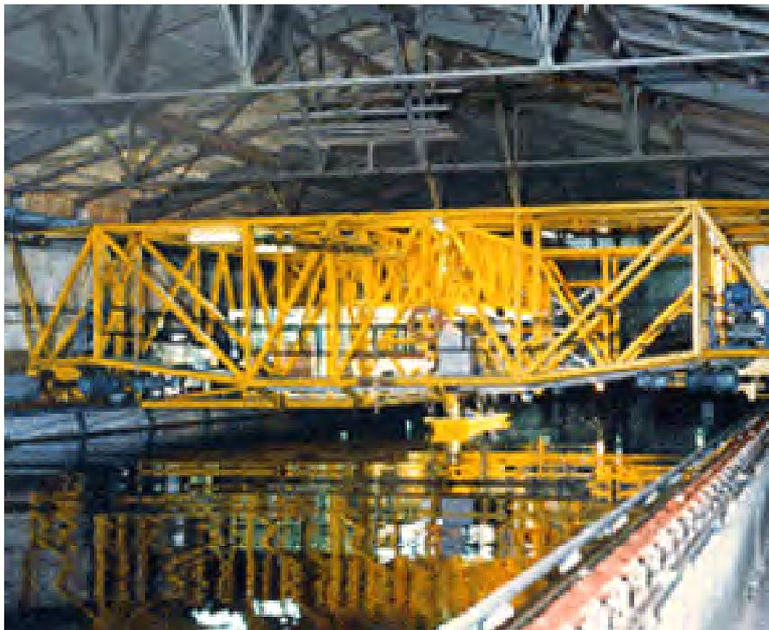
그림 3.3.22 Towing Tank (L\*W\*D > 200\*16\*7) in KORDI
