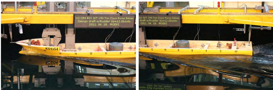
그림 3.1.27 Photographs of the Running Ship Model(KS1354, Design draft, 12.0 knots)
