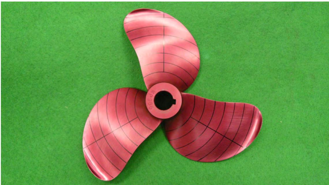
그림 3.3.24 KF-3-50-55(AE/AO=0.50, P/D=0.55) Model Propeller (Pressure Side)
