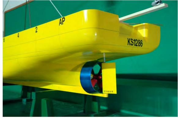
그림 3.1.17 모형선에 설계 덕트-프로펠러가 부착된 상태
