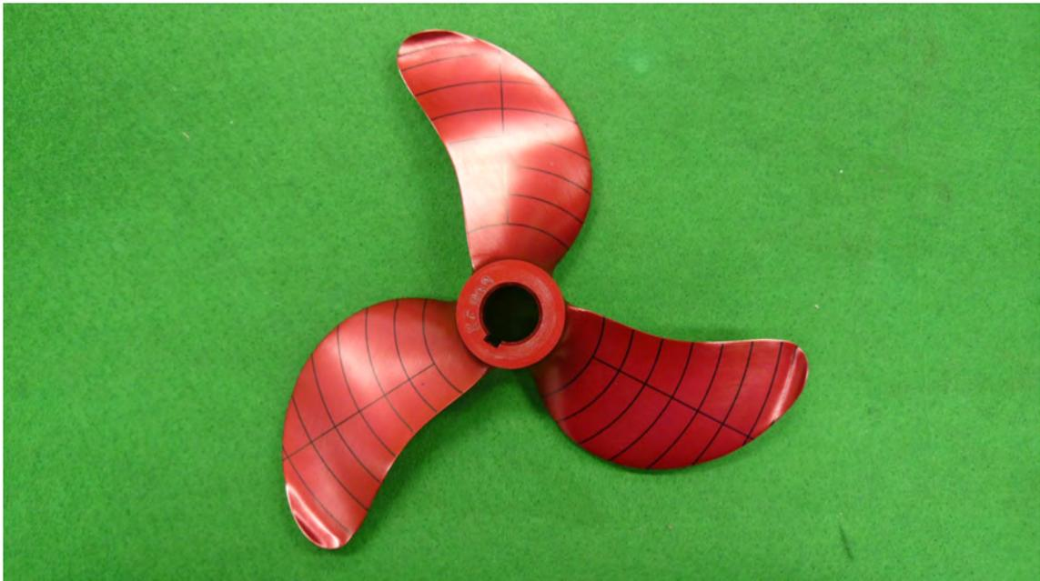
그림 3.3.26 KF-3-35-55( $AE/AO=0.35$ ,  $P/D=0.55$ ) Model Propeller (Pressure Side)
