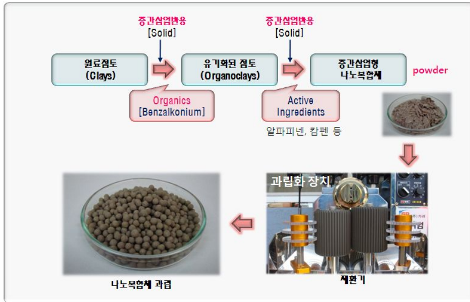
Fig. 69. 별도의 과립 바인더를 제외하는 과립 제조 공정도
