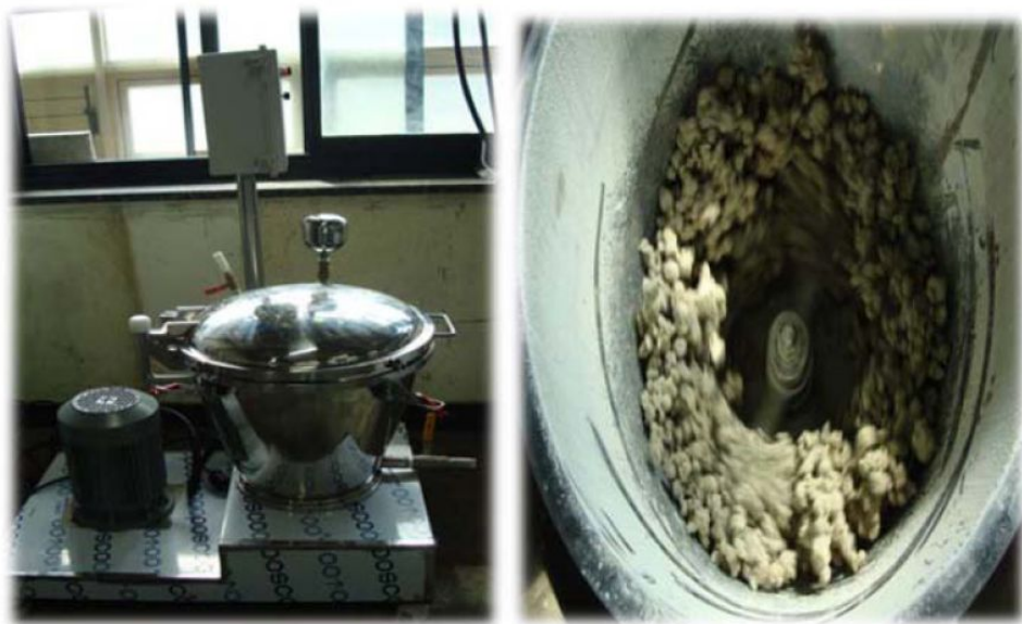
Fig. 74. High-speed mixer 실물사진 및 작업도
