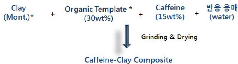
Fig. 48 점토의 종류에 따른 카페인-점토의 나노복합체에 합성공정 (고상반응법)
