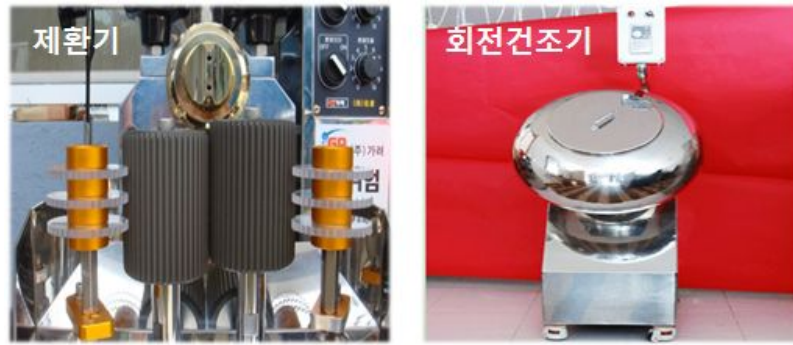
Fig. 70. 구형과립 제조용 제환기 및 열풍형 회전건조기
