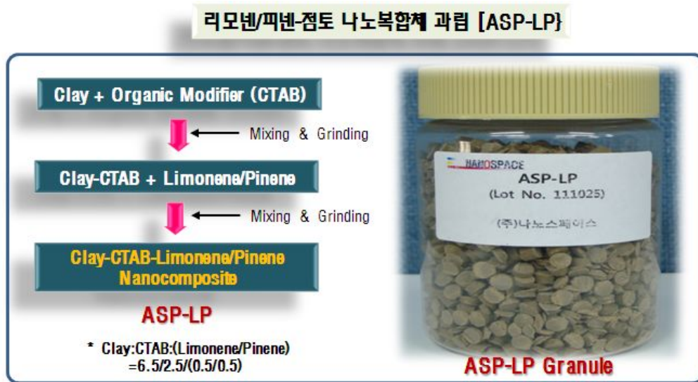
Fig. 80 펠렛성형기를 이용한 리모넨-피넨 함유 과립제조 공정
