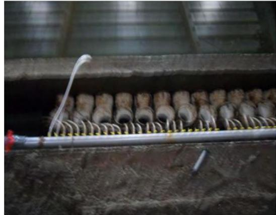
그림 3-39. 무환수시스템(BFT) 사육수조의 에어 및 수류 공급 장치
