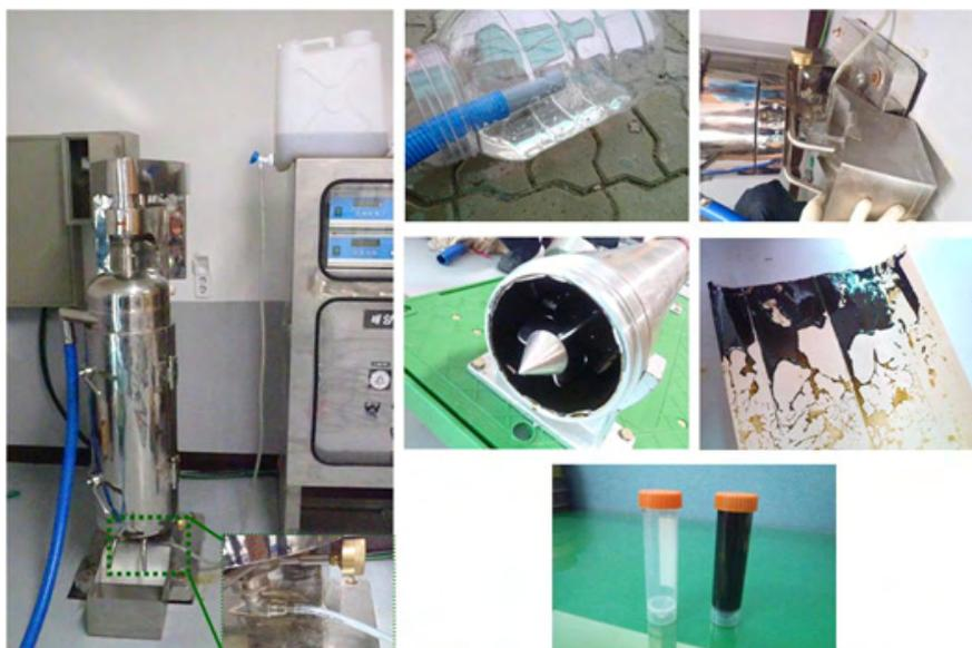
그림 6-4. 튜블러원심분리기를 이용한 미세조류 농축 및 수확 과정
