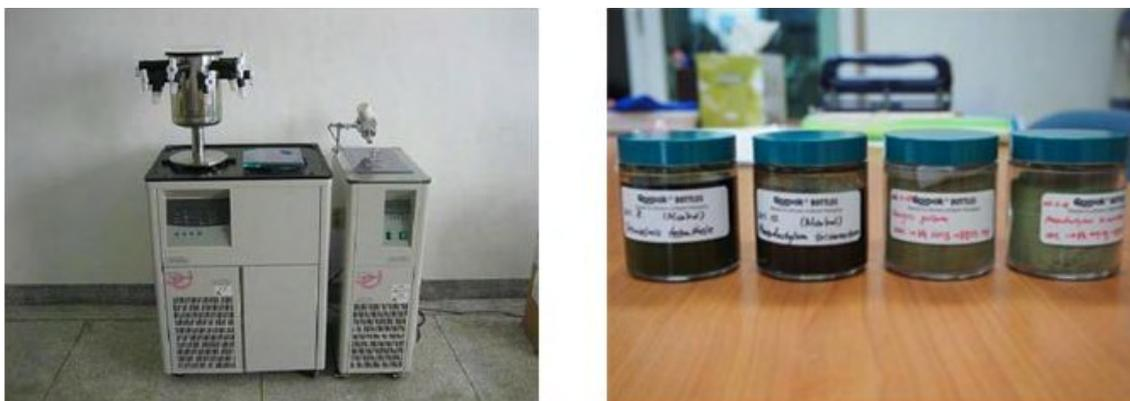
그림 6-5. 동결건조기를 이용한 미세조류 건조분말화
