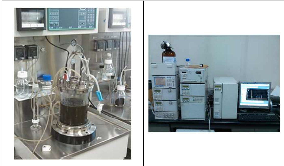
[그림 5-3-2] 실험에 이용된 2L Bioreactor 및 HPLC의 사진
