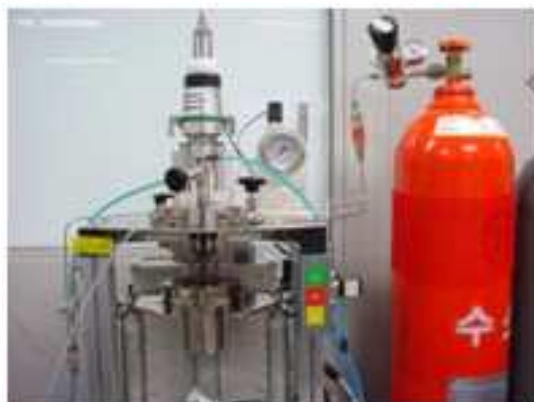
[그림 5-5-7] 바이오오일 업그레이딩 실험 장치
