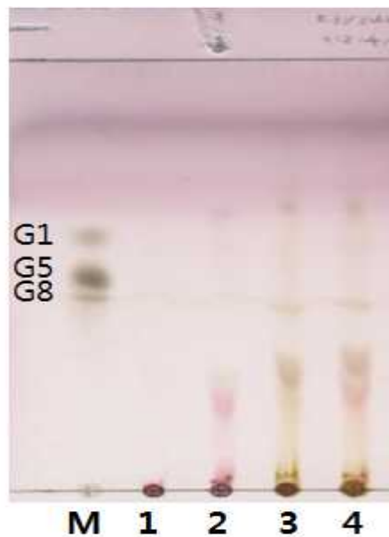
[그림 4-3-3] 박막 크로마토그래피를 활용한 감마선 조사 및 미생물 효소 융합 전처리 적용시 알긴산 올리고당 생산 수율 증진을 확인한 결과이다. 무처리 대조군 (lane 1), 감마선조사 10kGy 처리구(lane 2), 미생물 효소 처리구(lane 3), 미생물 효소 및 감마선조사 융합기술 처리구(lane 4)이며, M은 G1(글루코즈), G5(셀로펜타오즈), G8(셀로옥타오즈)의 표준혼합물이다.
