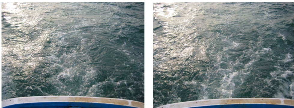
Fig. 3.4.3 선속 5km/h에서의 선미와 선수 Wave Pattern (4.5kW BLDC 모터 추진)
