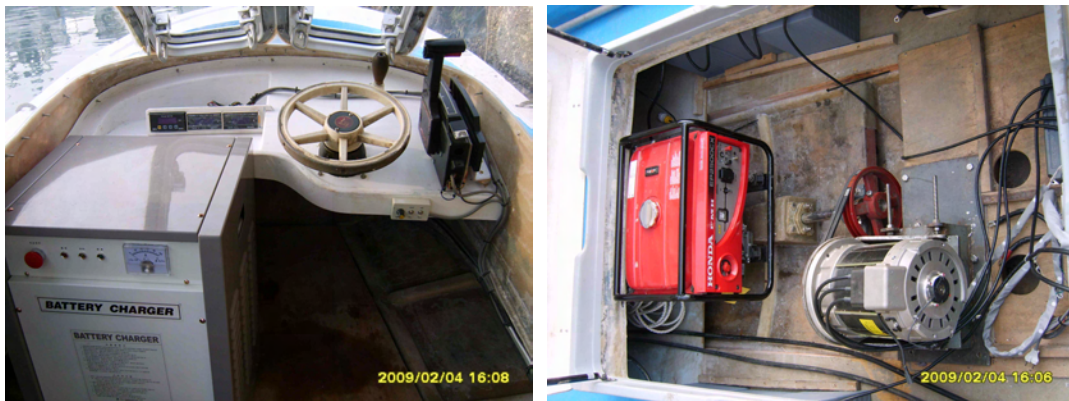
Fig. 3.3.19 기존 1ton급 낙지잡이 어선의 전기추진 시스템(10kW AC 모터)
