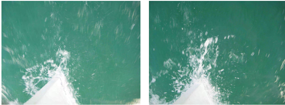
Fig. 3.4.4 선속 8km/h에서의 선미와 선수 Wave Pattern (4.5kW BLDC 모터 추진)
