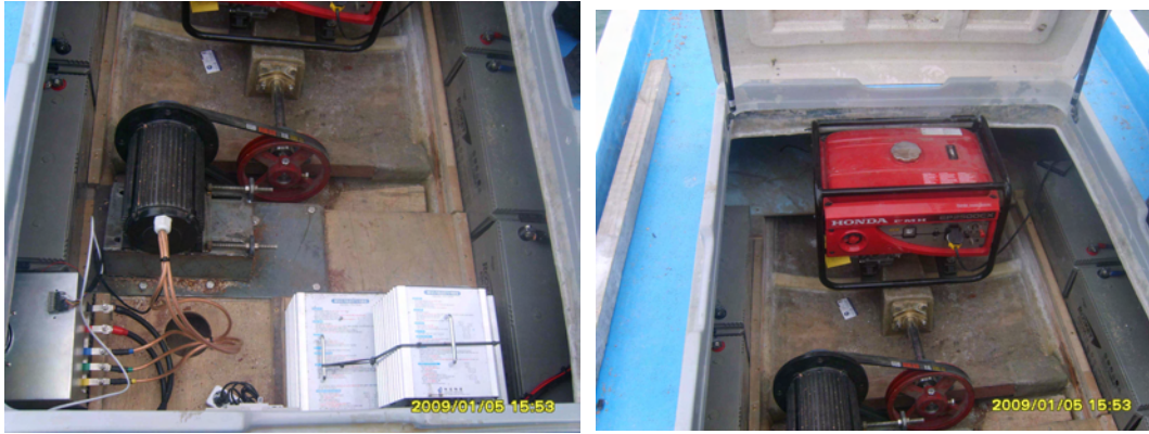
Fig. 3.3.18 기존 1ton급 낙지잡이 어선의 전기추진 시스템(4.5kW BLDC 모터)
