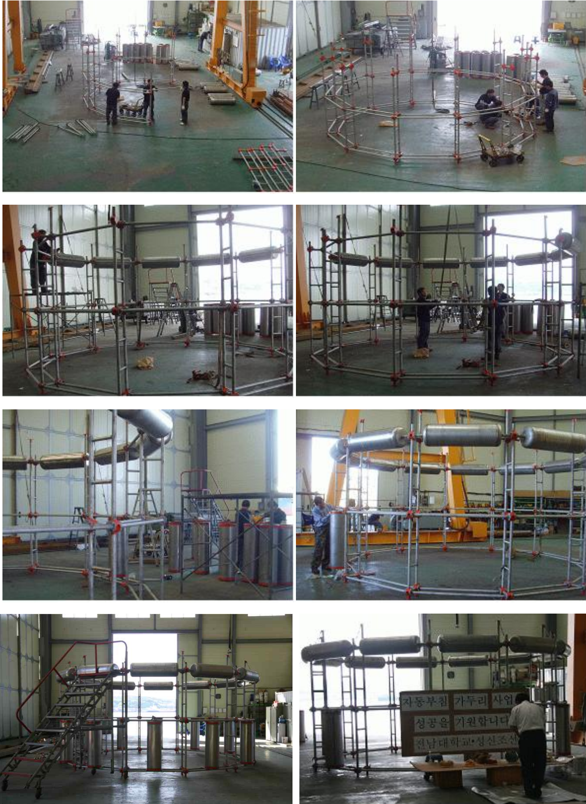
<그림 3-137> 자동 부침 가두리 1차 시작품 프레임 및 부자 조립 작업.
