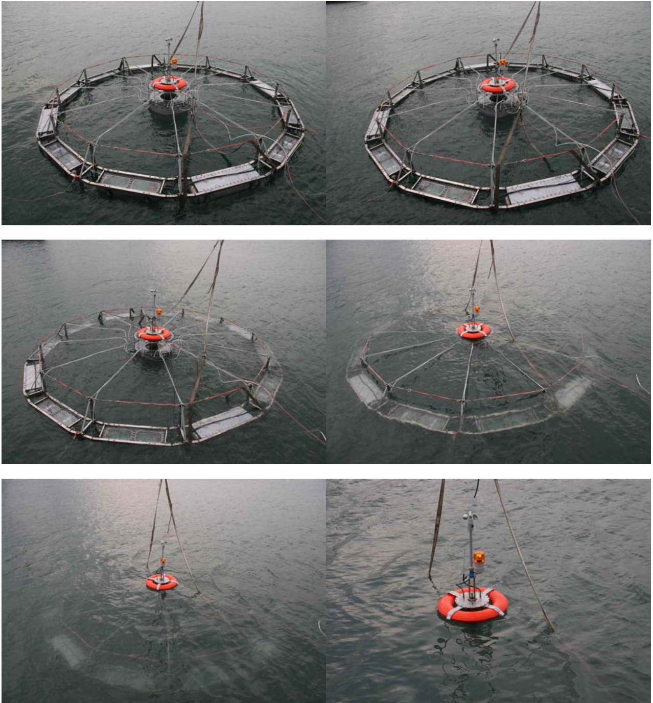
<그림 3-183> 2차 시작품의 자동 침하 과정.
