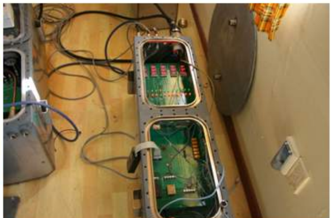
<그림 3-153> 리모컨에 의한 2차 시작품의 자동 침하 및 부상 작동 실험(실내).
