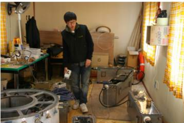
<그림 3-153> 리모컨에 의한 2차 시작품의 자동 침하 및 부상 작동 실험(실내).
