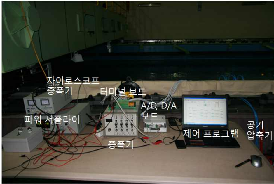
<그림 3-112> 자동 부침 가두리 시설의 부침 기능 재현 실험에 사용된 장치의 구성.
