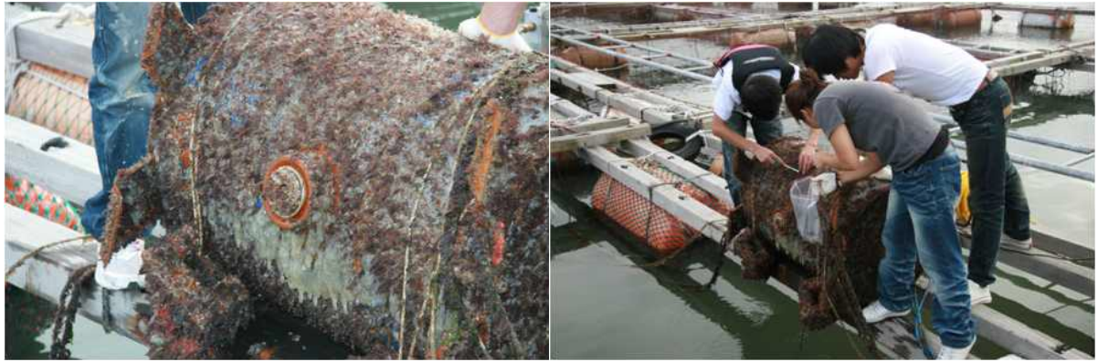
<그림 3-164> 해상에 설치한 후 50일이 경과된 부침 부자의 상태.
