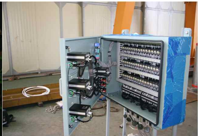
<그림 3-143> 1차 시작품의 부침 제어반(상) 및 작동 시험(하).
