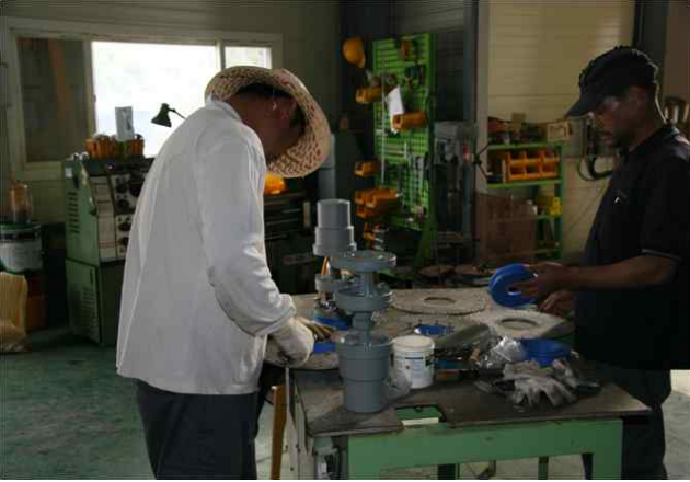
<그림 3-138> 피스톤 밸브 조립(좌) 및 부침 부자의 내부 구조(우).
