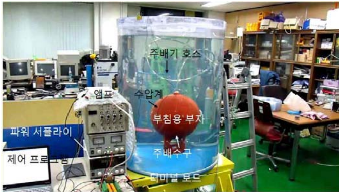
<그림 3-99> 부침용 부자의 자동 부침 실험에 사용된 모델 및 계측 장치.
