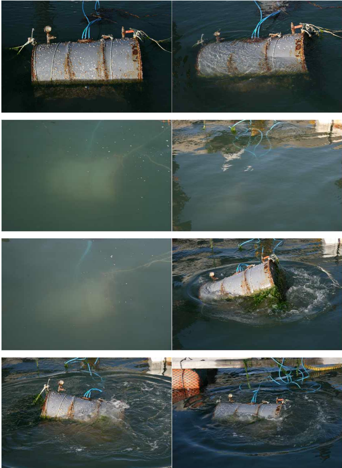
<그림 3-169> 해상에 설치 후 5개월이 경과된 부침 부자의 성능 실험.
