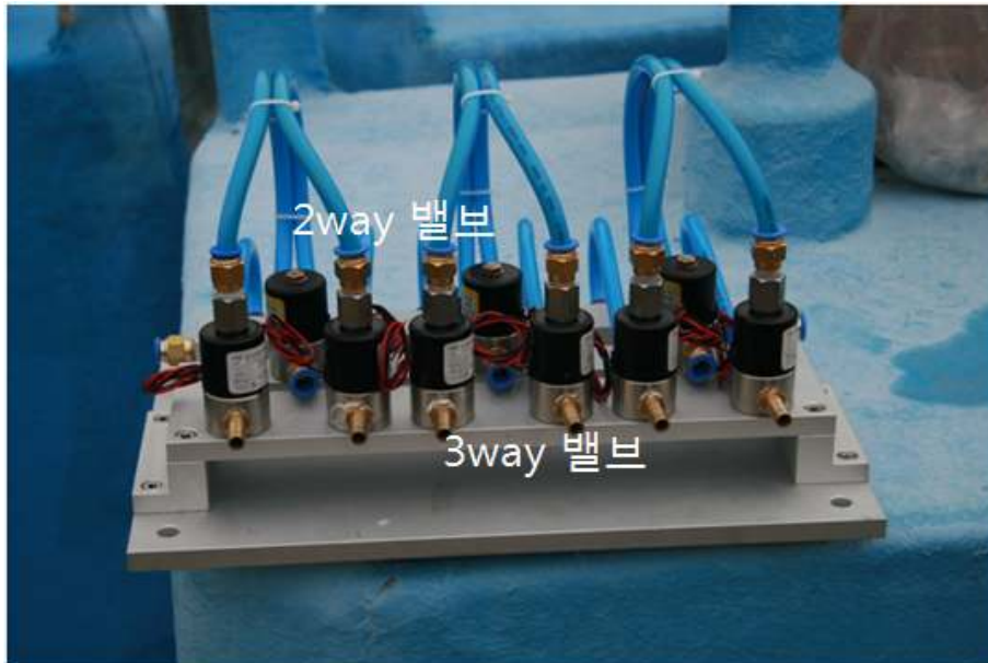
<그림 3-105> 3-way(6개) 및 2-way(3개) 밸브로 구성된 자동 부침 가두리 시설의 메니폴드.
