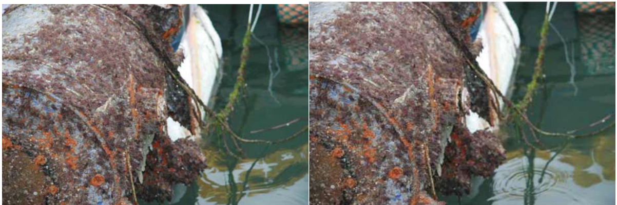
<그림 3-164> 해상에 설치한 후 50일이 경과된 부침 부자의 상태.
