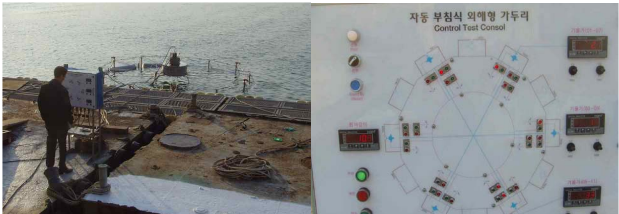
<그림 3-174> 1차 시작품의 침하와 부상을 제어하기 위한 컨트롤 패널 작동 사진.
