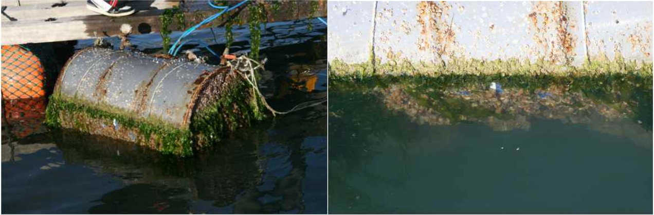
<그림 3-167> 해상에 설치 후 5개월이 경과된 부침 부자의 상태.
