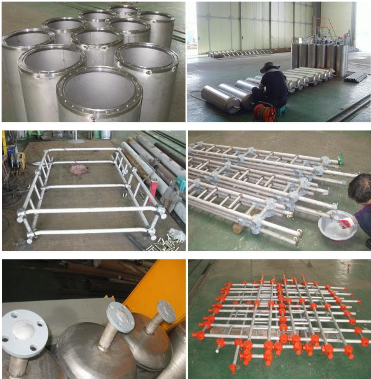
<그림 3-136> 자동 부침 가두리 1차 시작품 구성 부품 가공 및 마감 처리 작업.
