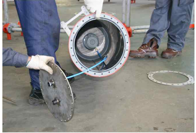
<그림 3-138> 피스톤 밸브 조립(좌) 및 부침 부자의 내부 구조(우).
