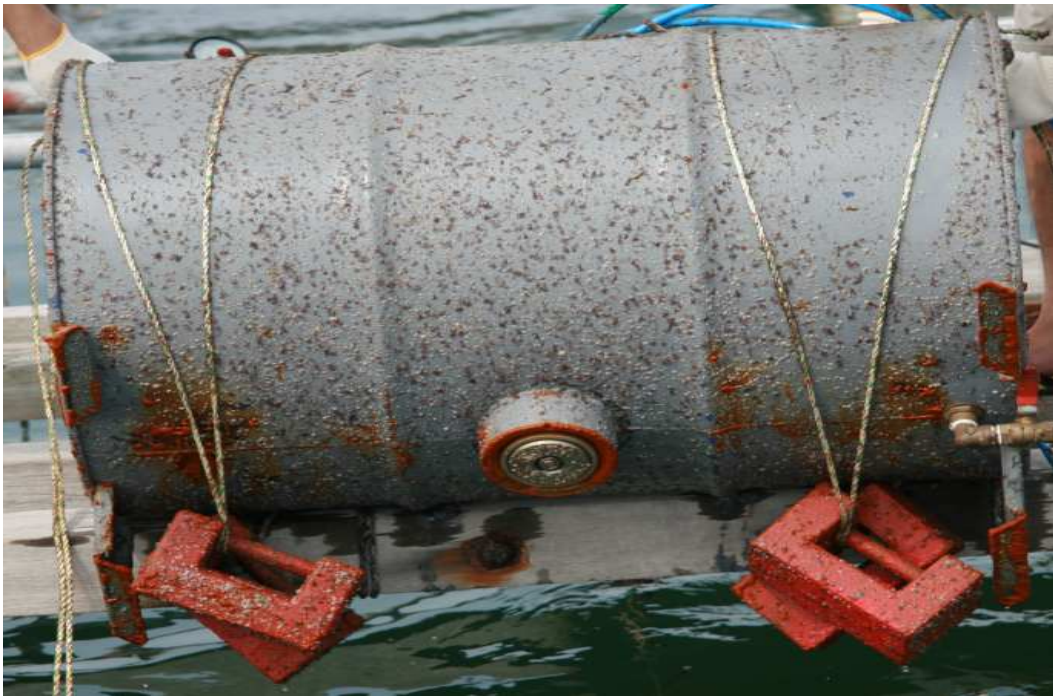
<그림 3-162> 해상에 설치한 후 20일이 경과된 부침 부자의 상태.
