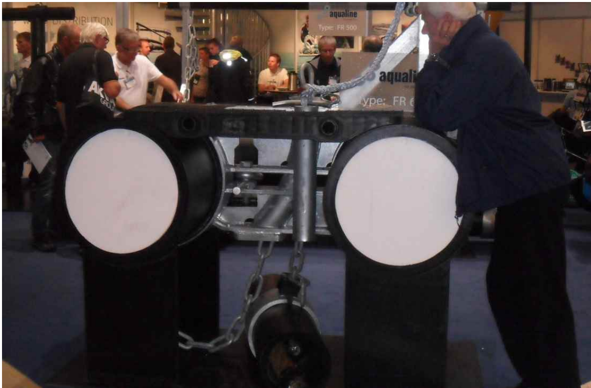
<그림 6-5> 철과 고밀도 PE 파이프로 구성된 가두리 프레임.
