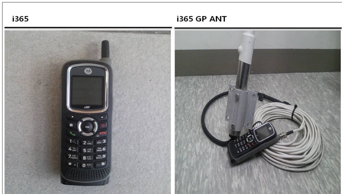
<그림 III-39> 전파품질 측정에 사용한 TRS 단말장치 구성(1)
