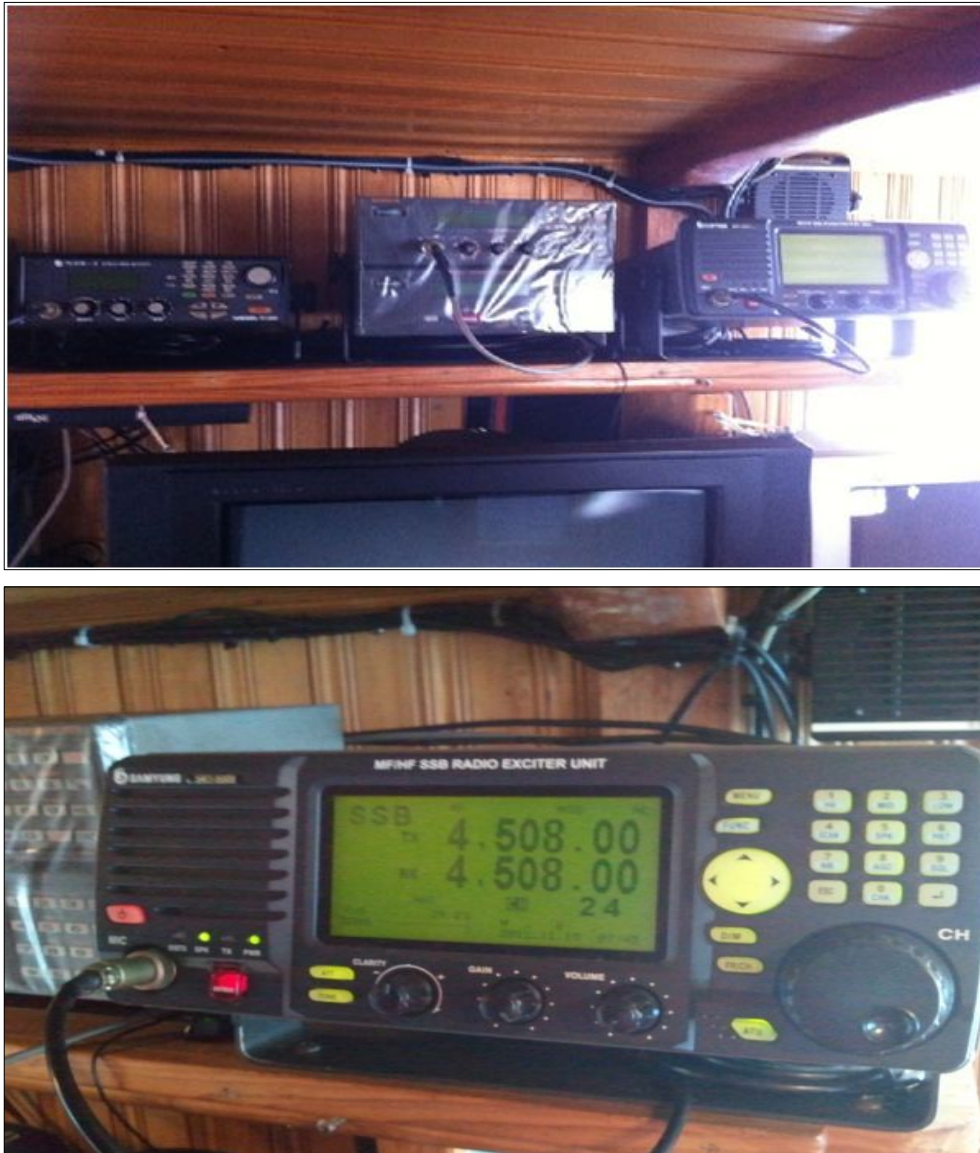
<그림 II-9> 남해 근해어선 통신장치의 조사 모습(제주 남경호 SSB통신장치)
