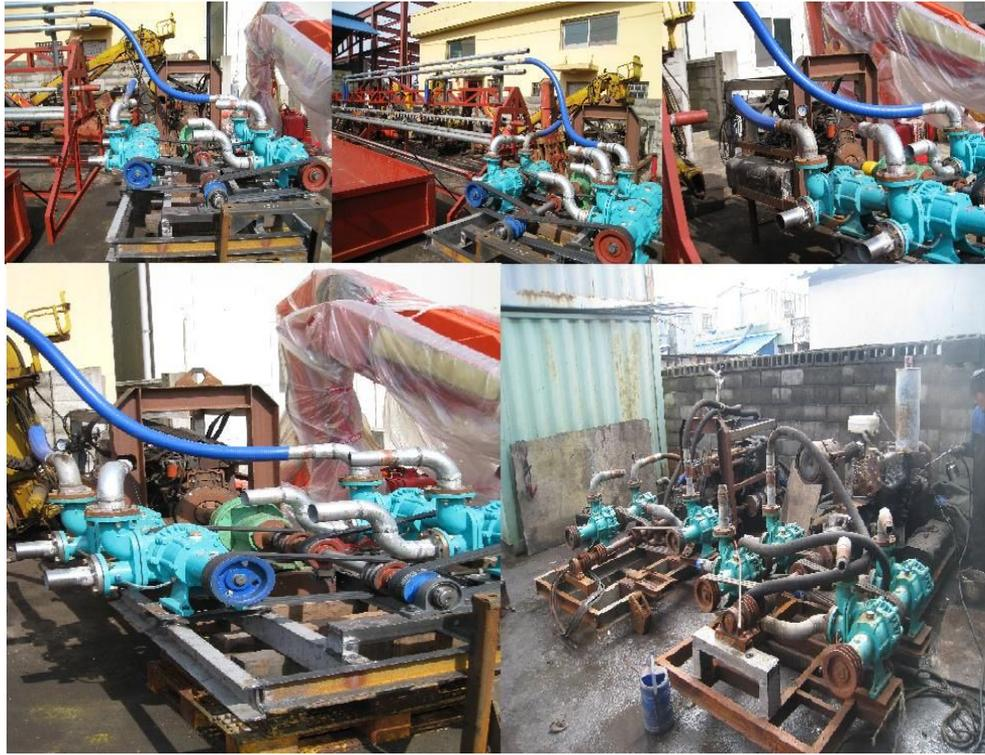
(그림 26.)2차 세척시스템의 동력 Part 시작품 제작 모습
