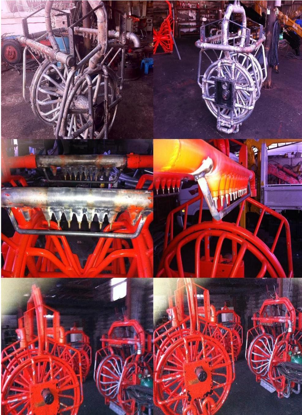
(그림 20.)1차 그물세척 시스템 양망 세척 파트 시험품 제작 모습
