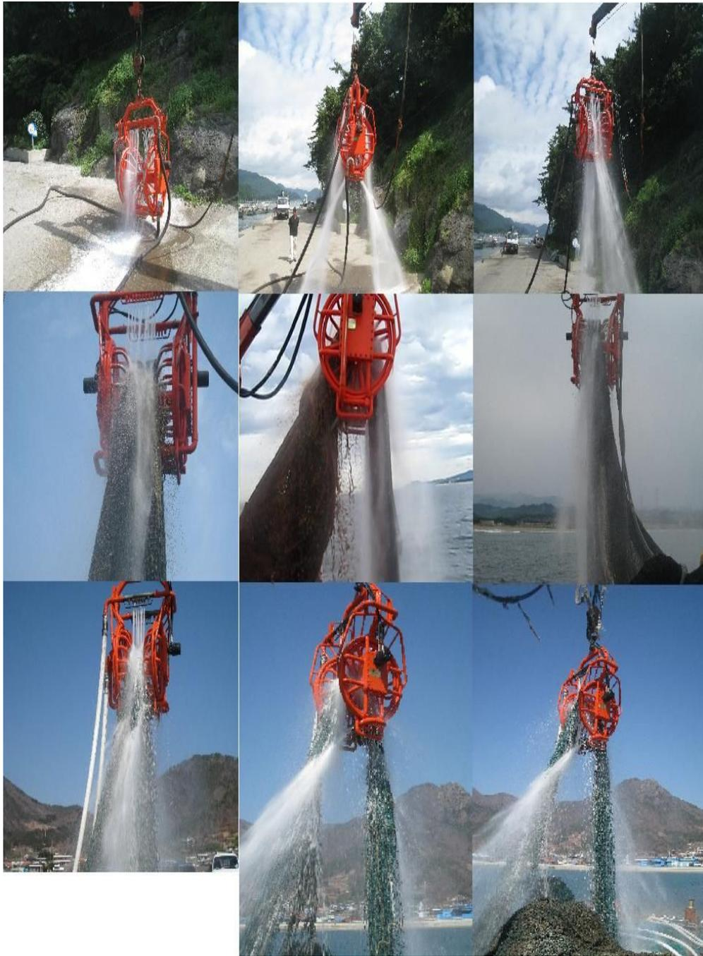
(그림 22.)1차 그물세척 시스템 시험품 성능시험 모습
