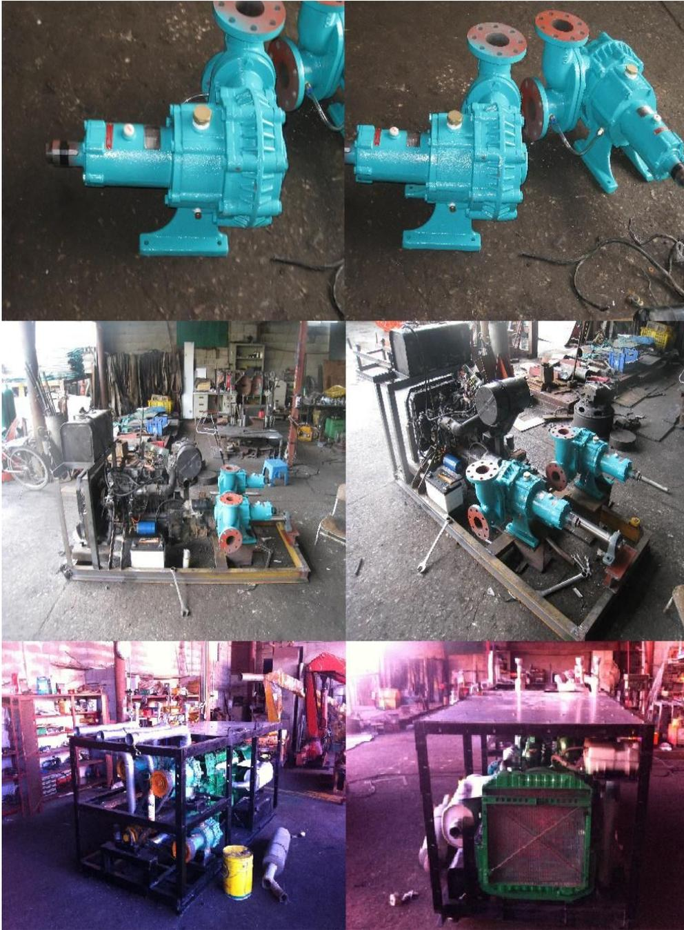
(그림 21.)1차 그물세척 시스템 동력 전달 파트 시험품 제작 모습
