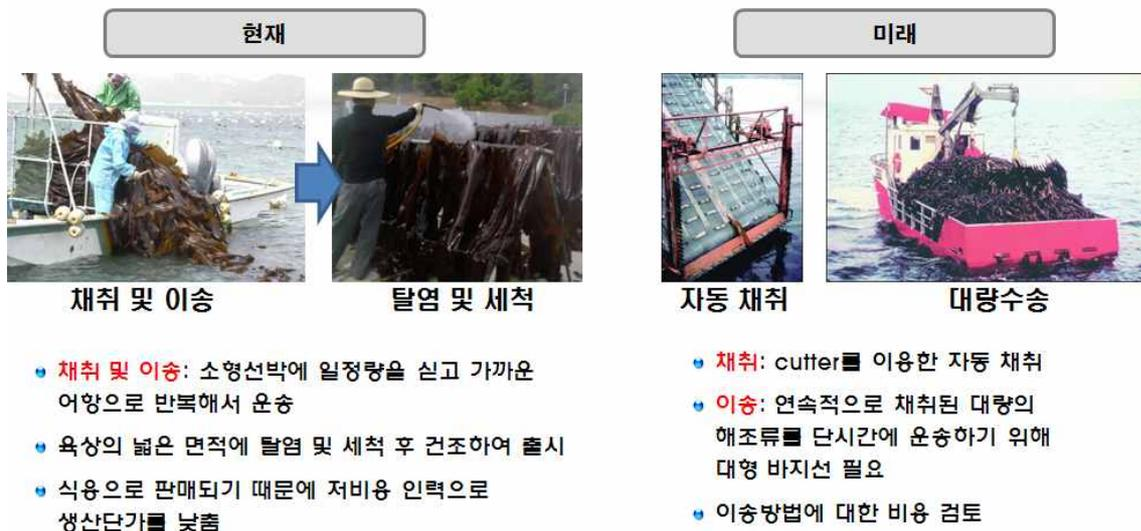
[그림 4-2-2] 양식시설 채취 및 이송 시스템의 현재와 미래.
